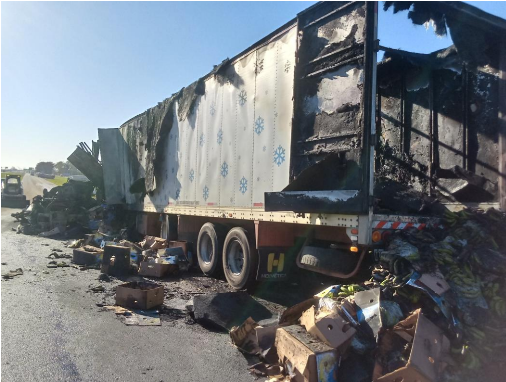
Figura 18. Fotografía del semirremolque incendiado del Vehículo 1. Fuente: JST, 2021.
