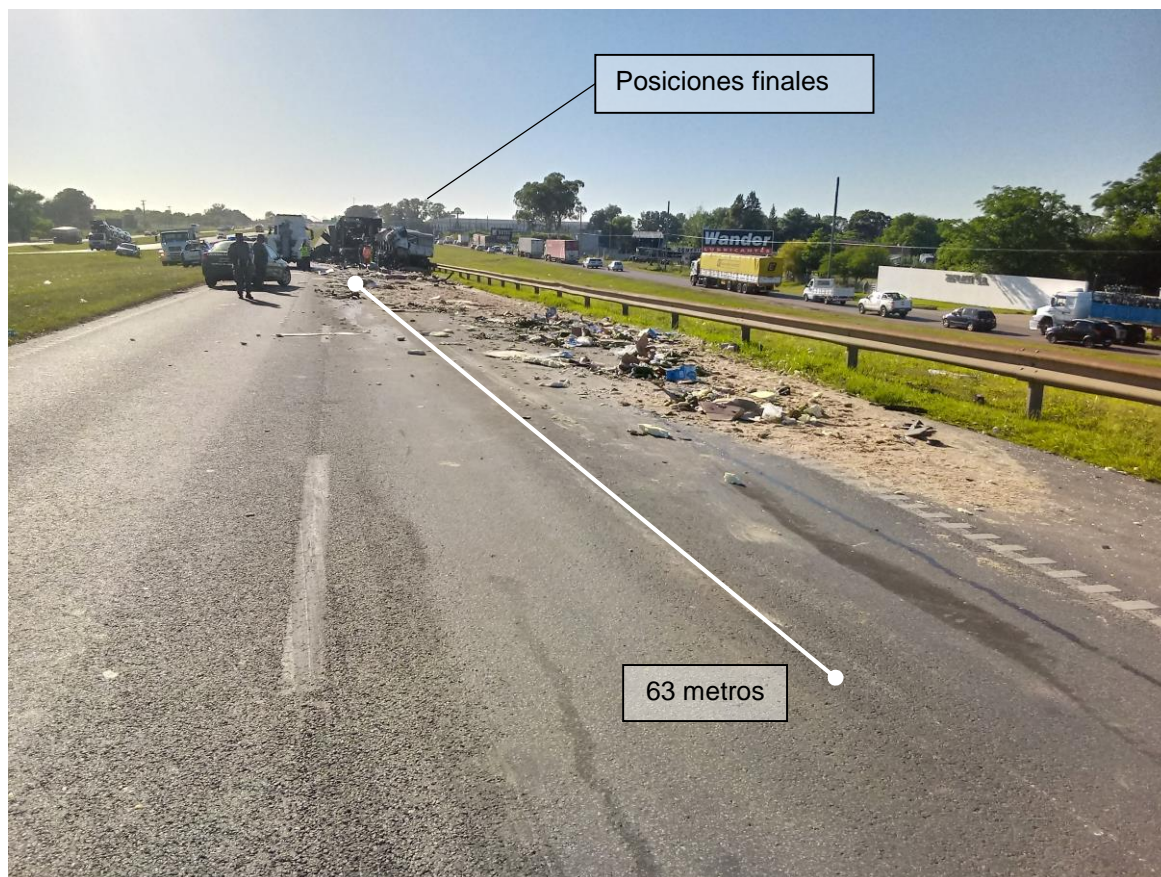
Figura 13. Fotografía del desplazamiento de los vehículos desde área geográfica de impacto hasta la posición final de los mismos. Fuente: JST, 2021.
