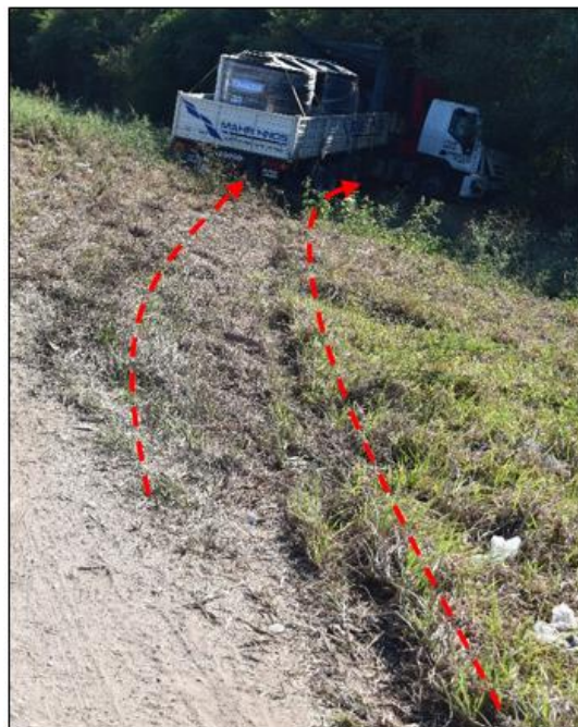
Figura 13. Fotografías de las huellas de derrape demarcadas por ruedas de unidad tractora y semirremolque sobre el talud y zona de préstamo. Fuente: JST, 2021.
