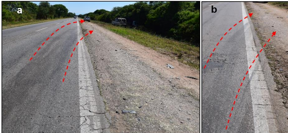
Figura 12. Fotografías de las huellas de derrape demarcadas por ruedas del segundo eje dual del semirremolque sobre la calzada luego del impacto. Fuente: JST, 2021.
