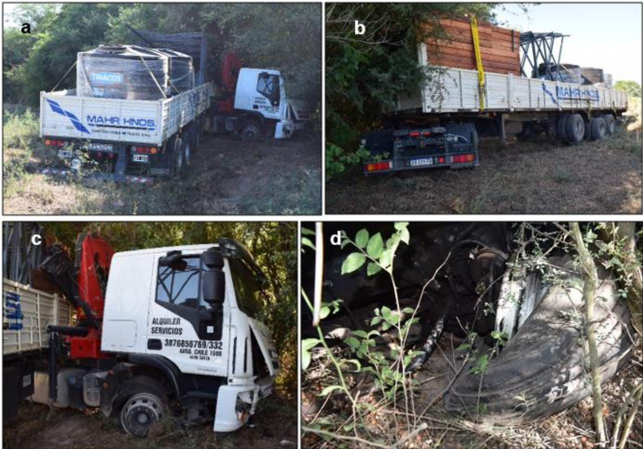
Figura 8. Fotografías del estado del camión y semirremolque (a y b). Se observan los daños principales de la unidad tractora en el sector frontal que comprometieron los sistemas de dirección y suspensión del eje delantero (c y d).
