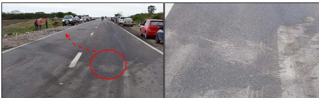
Figura 8. Ubicación de la zona de impacto (a) y las huellas de efracción demarcadas (b) en instantes inmediatamente posteriores a la colisión. Se indica el sentido y dirección de las huellas en coincidencia con la trayectoria post colisión del furgón. Fuente: JST, 2021.
