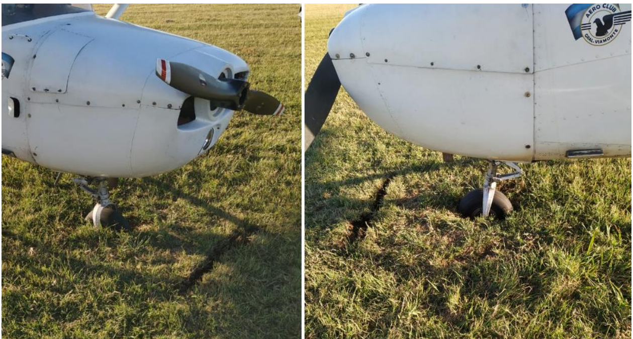
Figura 2. Imagen de la rueda de nariz dentro del pozo
