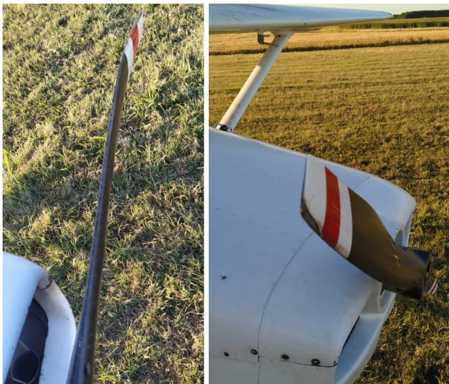
Figura 3. Daños en la hélice
