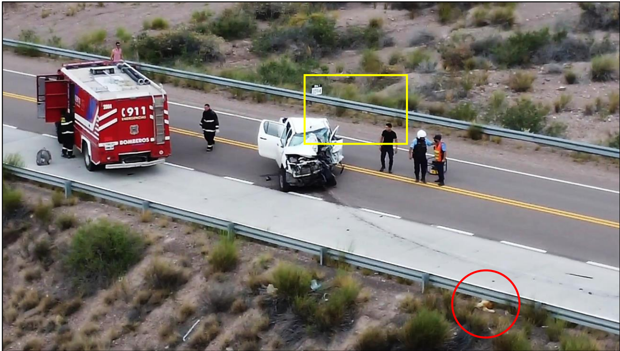
Figura 6. Fotograma de filmación con VANT. Posición final del Vehículo 2 sobre el carril de circulación central (mano hacia el noroeste). Se observa, dentro del rectángulo superior, la banquina libre de elementos, y dentro del círculo inferior, la presencia de un perro muerto debajo de la defensa lateral.
