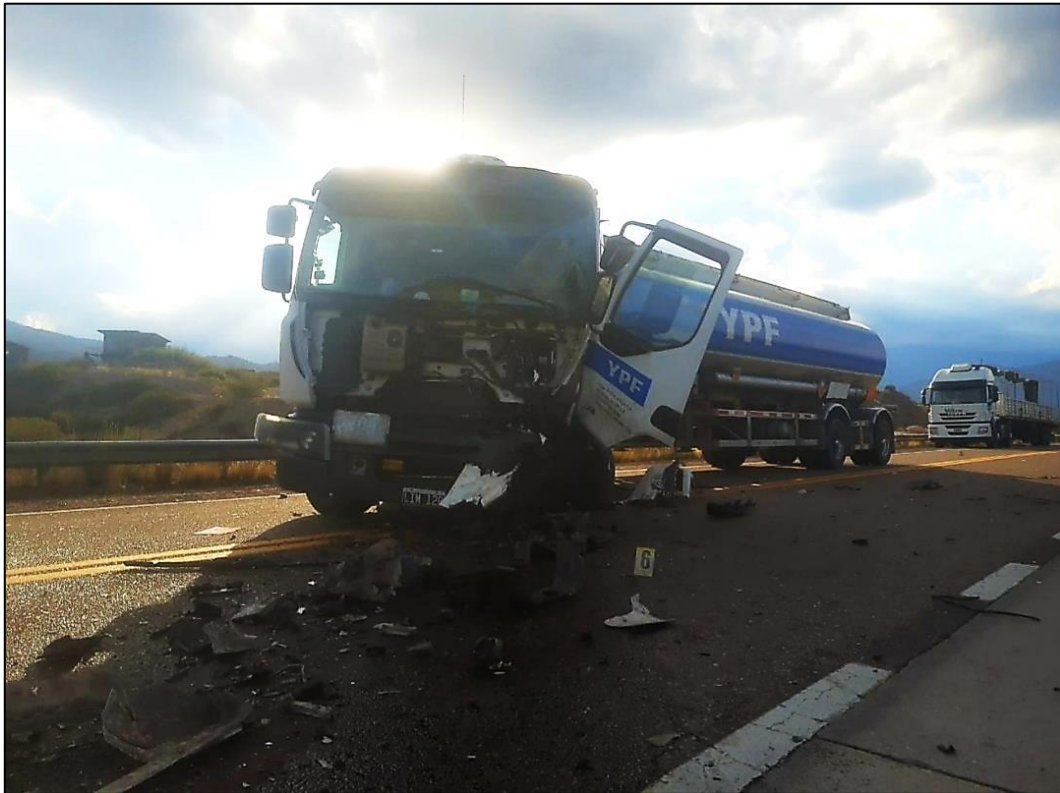
Figura 23. Daños materiales del Vehículo 1, ubicados principalmente en el sector frontal de la cabina.
