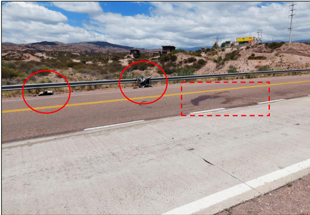
Figura 18. Posición final Vehículo 2. Se puede observar sobre el sector medio de imagen de izquierda a derecha; perro muerto (banquina oeste), restos vehiculares (puerta del Vehículo 2) y manchas de fluidos vehiculares sobre el carril central. Fuente: JST, 2021.
