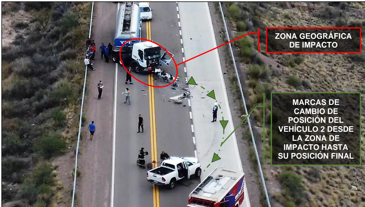
Figura 4. Fotograma de filmación con VANT. Posición final del Vehículo 1 y posición final del Vehículo 2 sobre la vía. Nótese dentro del círculo la zona geográfica de impacto y las flechas que señalan el trayecto del rodado menor posterior a la colisión. Fuente: Camioneros Internacionales , 2021.
