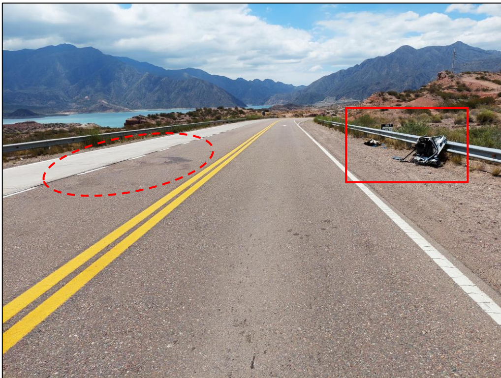
Figura 11. Vista de la posición final del Vehículo 2 desde el carril del Vehículo 1. Se pueden observar vestigios de fluidos vehiculares sobre el carril de circulación opuesto y demás indicios (fragmentos de carrocería y perro muerto) sobre la banquina, a la derecha de la imagen. Fuente: JST, 2021.
