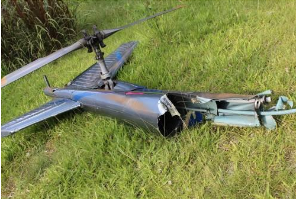
Figura 3. Botalón de cola seccionado del fuselaje del helicóptero
