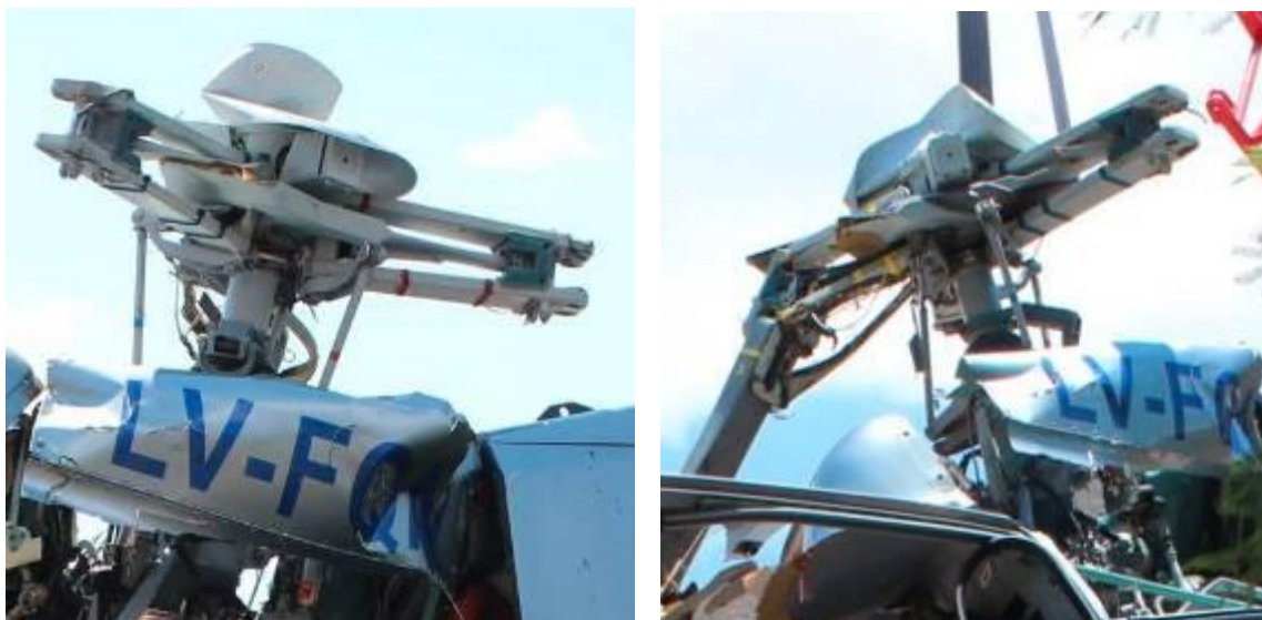
Figura 30. Barras control de ángulo de ataque (Pitch Link)
