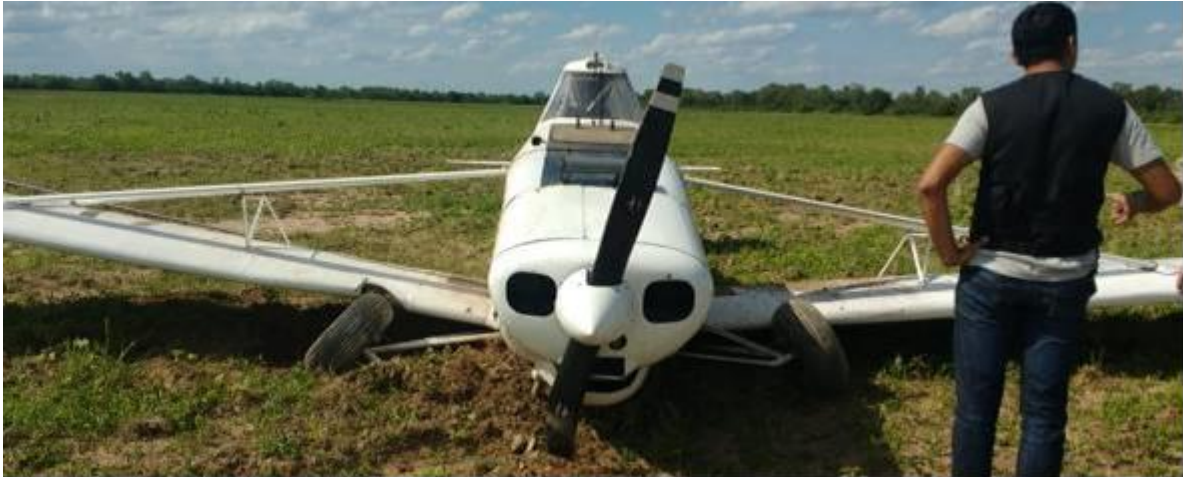
Figura 3. Vista general de daños en la aeronave: tren de aterrizaje principal colapsado
