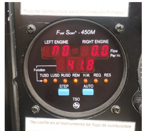
Figura 4. Indicadores de combustible (izquierda) y flujómetro digital (derecha)
