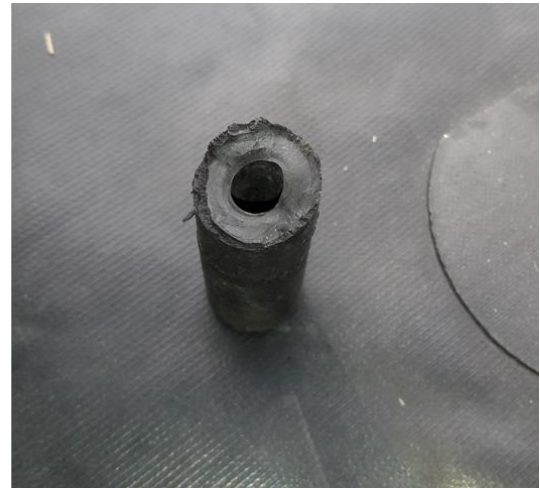
Figura 5. Rotura en uno de los acoples al sistema de cañerías del tanque de combustible del plano izquierdo
