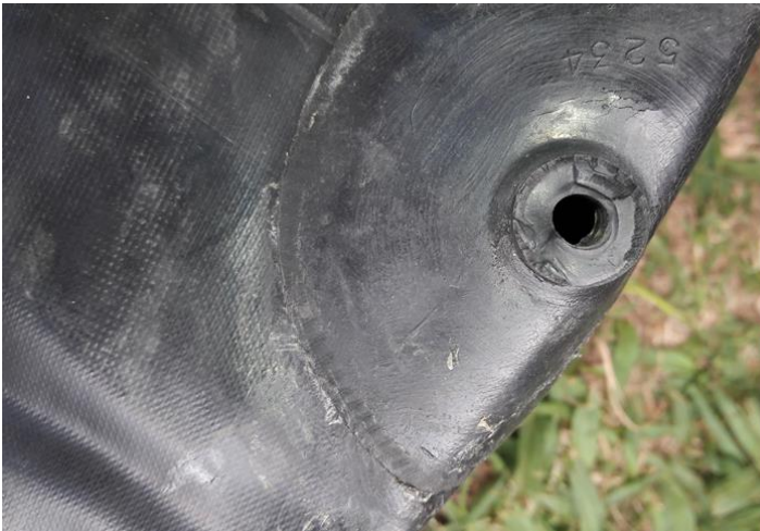
Figura 5. Rotura en uno de los acoples al sistema de cañerías del tanque de combustible del plano izquierdo
