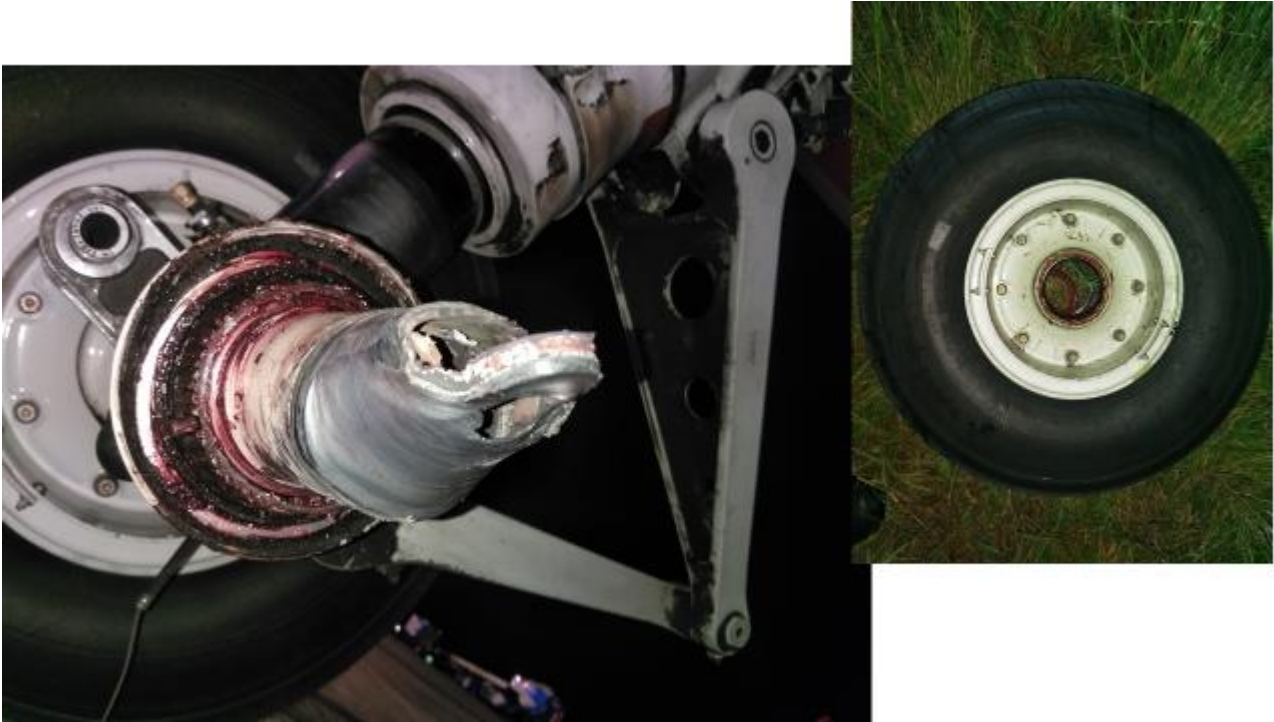
Figura 1. Extremo del eje y rueda en la condición encontrada
