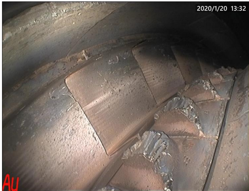
Figura 3. Daños en los álabes de HPT. Fuente: Austral
