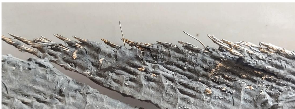
Figura 29. Exposición de cordones metálicos en el extremo de una tela
