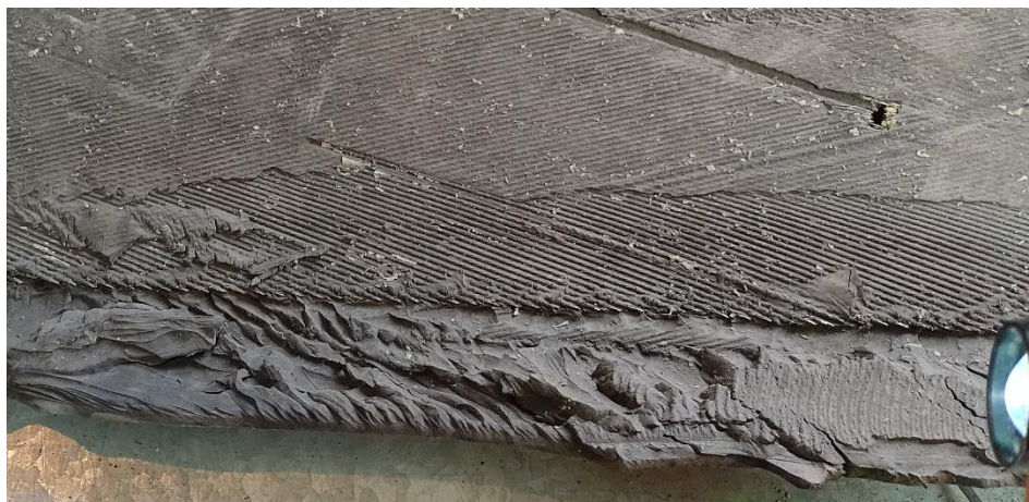
Figura 30. Superficie de fractura iluminada con luz rasante desde la derecha
