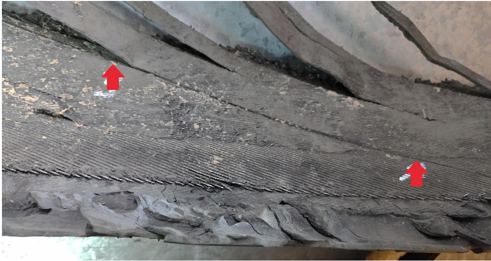
Figura 25. Faltante de un cordón sobre la tela adherida a la banda de rodadura
