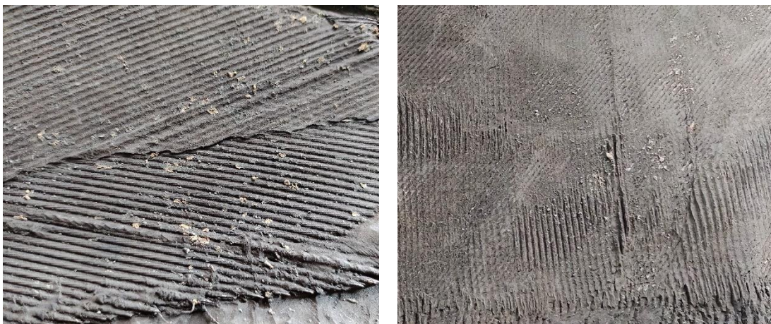
Figura 21. Marcas de los cordones metálicos sobre las partes secuestradas. A- Marcas diagonales. B- Marcas radiales
