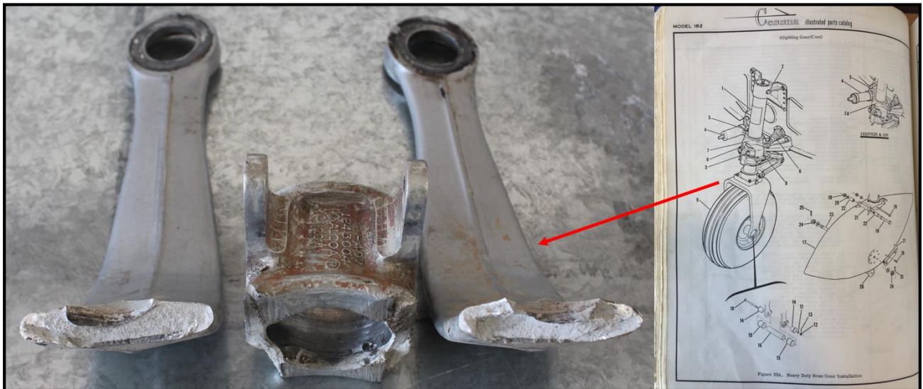
Figura 3. Imagen de los daños en la horquilla
