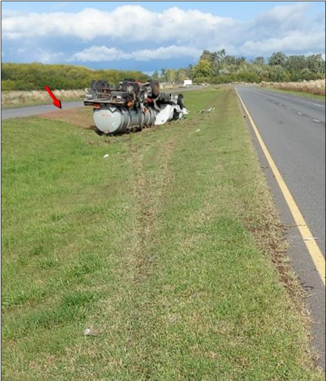
Figura 11. Vehículo en su posición final. Se indican con flecha roja signos de daño en el pasto del cantero central. Fuente: JST, 2022
