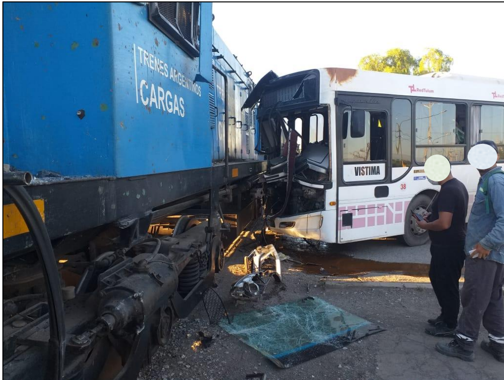
Figura 3. Posición y ubicación final del colectivo con visualización de sus daños
