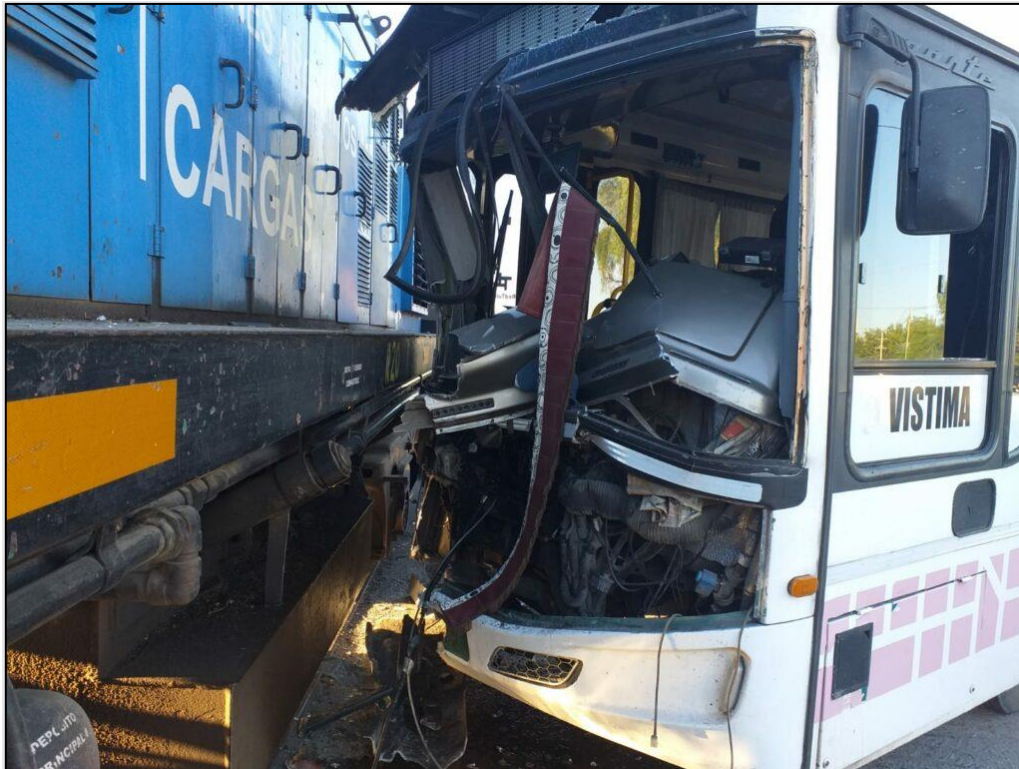
Figura 4. Posición y ubicación final del colectivo con visualización de sus daños
