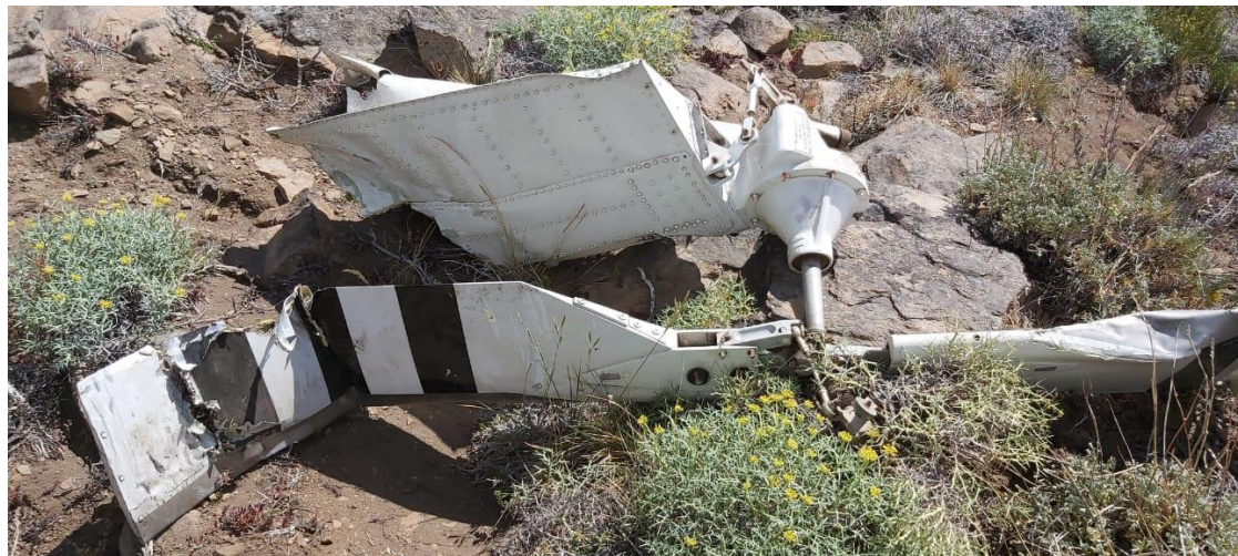
Figura 4. Daños en el rotor de cola
