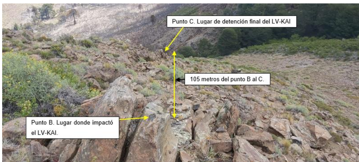
Figura 11. Marca dejada por el LV-KAI sobre una roca en el punto B, y punto C impacto final.
