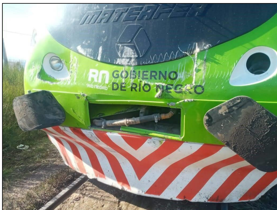
Figura 1. Daños en el sector frontal de la cabina del conductor
