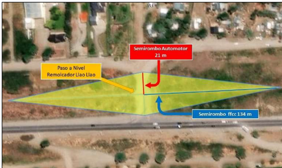
Figura 14. Rombo de visibilidad requerido, según Resolución SETOP 7/81
