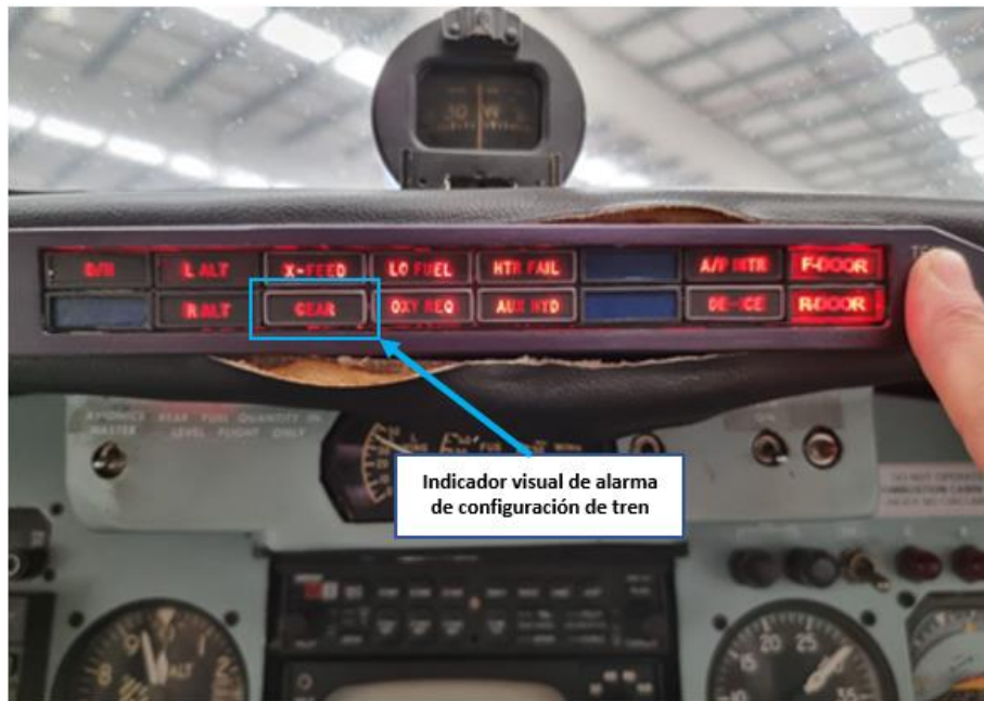
Figura 12. Verificación de encendido de lámparas de panel de alarma
