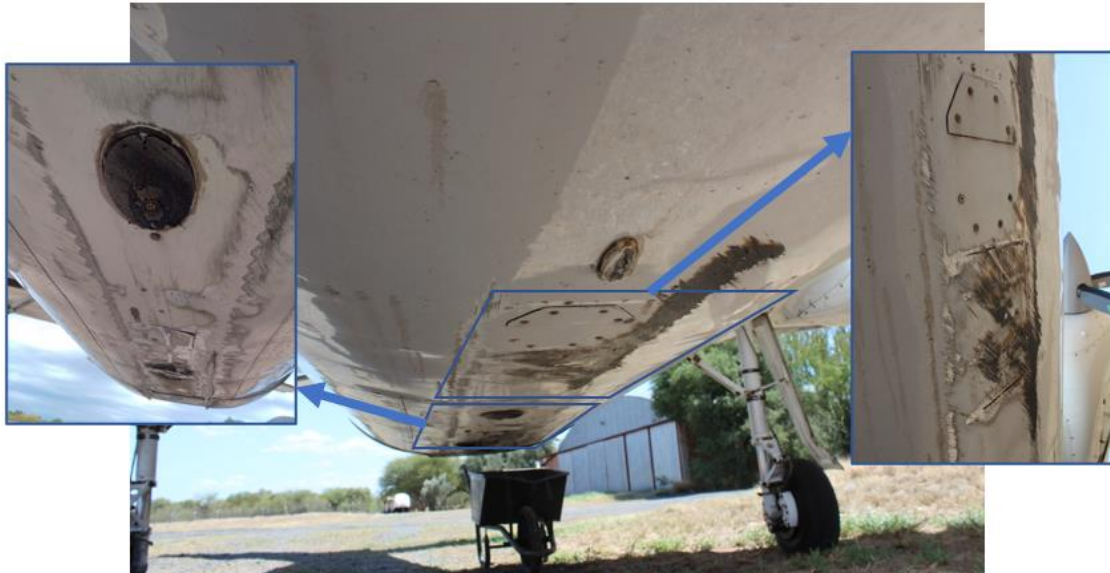
Figura 8. Vista de daños en la zona inferior del fuselaje
