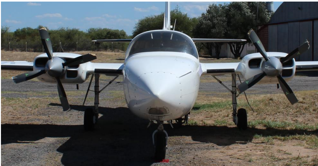
Figura 9. Vista de los daños en ambas hélices
