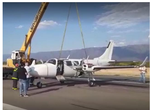
Figura 7. Elevación de la aeronave con grúa
