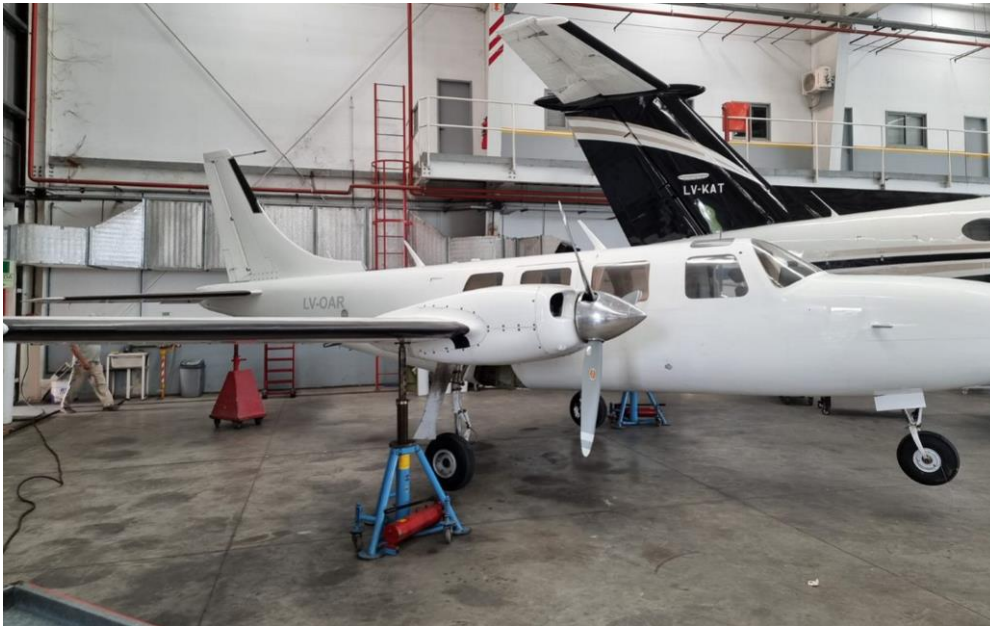
Figura 11. Ensayo de sistema de alarma de configuración de tren de aterrizaje
