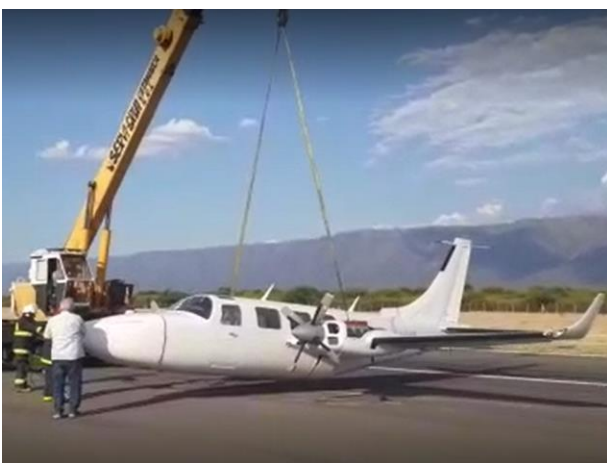
Figura 7. Elevación de la aeronave con grúa
