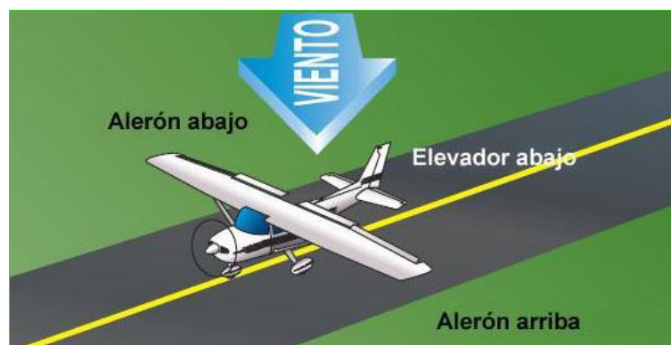
Figura 4. Representación de posicionamiento de comandos de vuelo respecto al viento en la fase de rodaje
