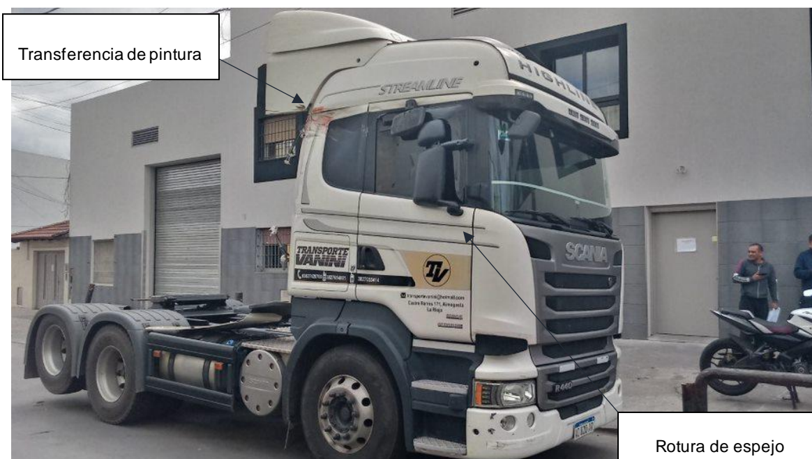
Figura 8. Daños en el espejo retrovisor y panel superior derecho del Vehículo 2. Fuente: JST, 2022
