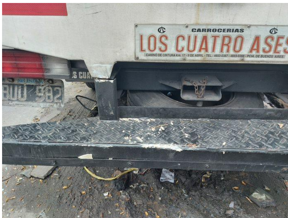
Figura 14. Transferencia de material correspondiente al paragolpes frontal del Vehículo 3. Fuente: JST, 2022
