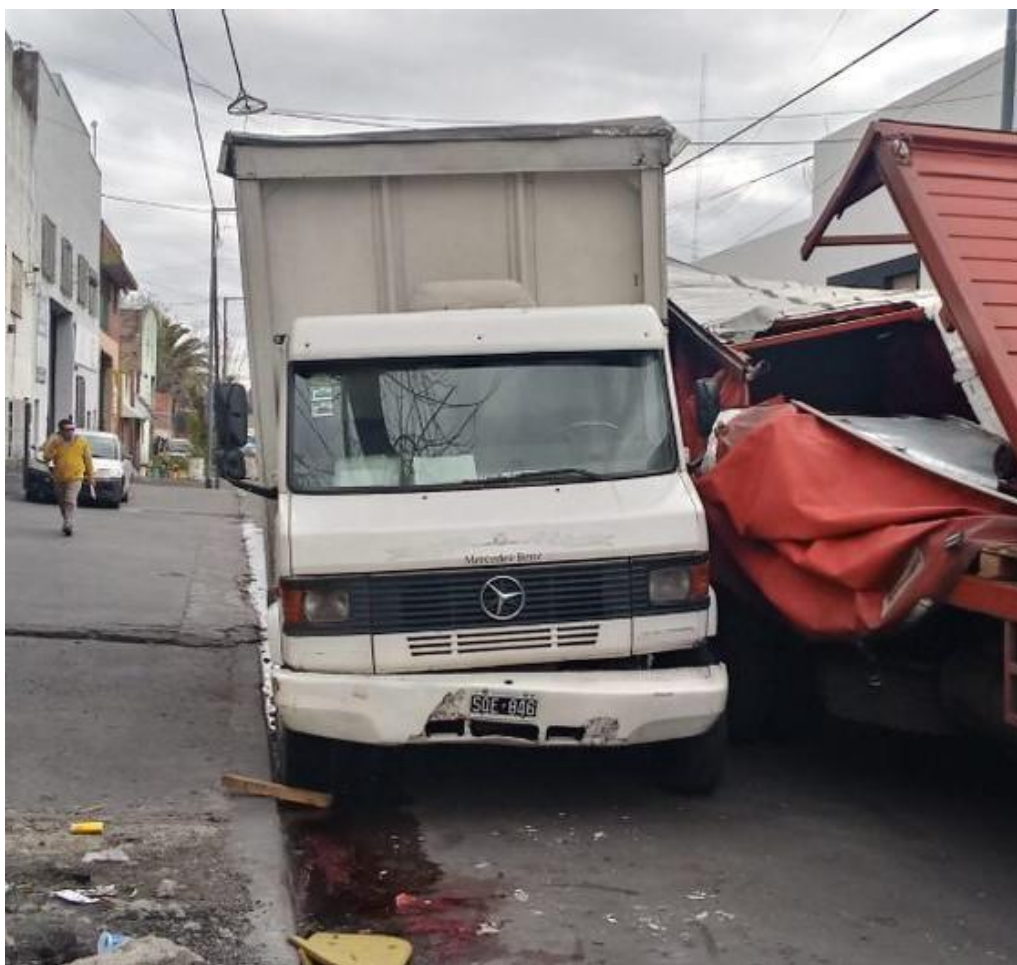
Figura 10. Desprendimiento parcial del paragolpes en sector frontal del Vehículo 3. Fuente: JST, 2022.
