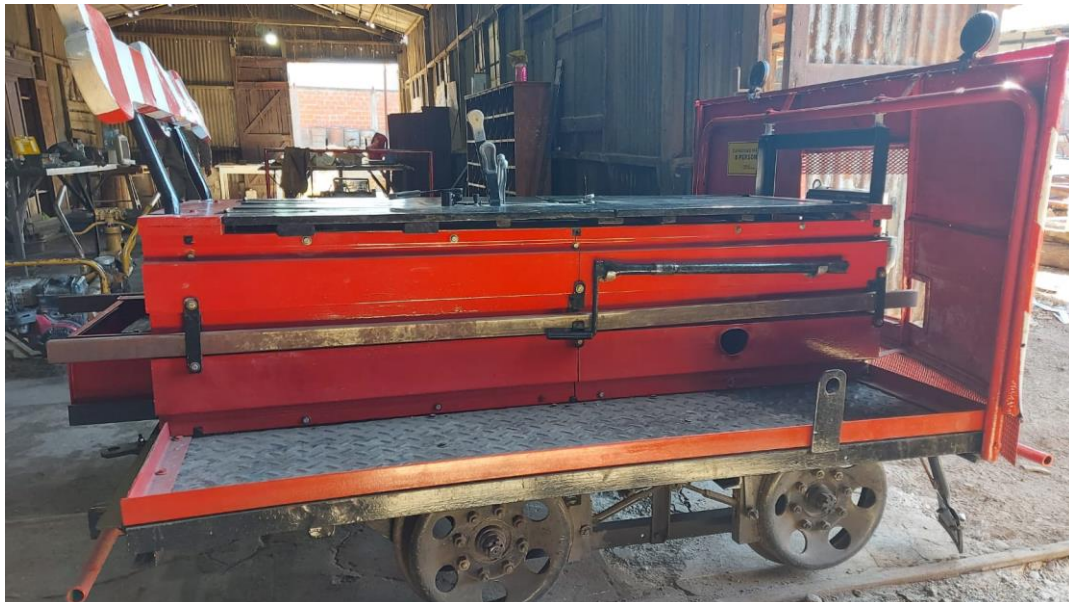
Figura 7. Zorra a motor nueva, construida con partes de la zorra accidentada. Fuente: JST, 2022
