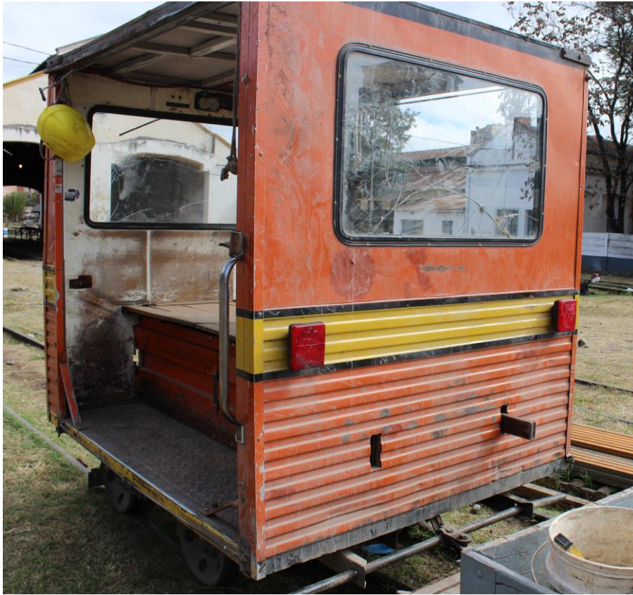
Figura 11. Parabrisas de la zorra con fisuras. Fuente: JST, 2021
