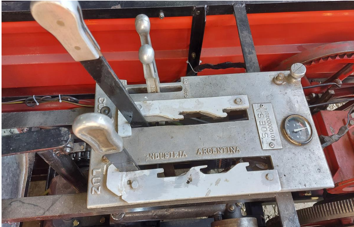
Figura 8. Placa identificatoria de los comandos de la zorra accidentada (ver fig.16) reutilizada en la nueva zorra a motor. Fuente: JST, 2022
