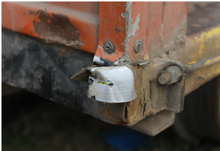
Figura 12. Marcas de impacto en la carrocería. Fuente: JST, 2021
