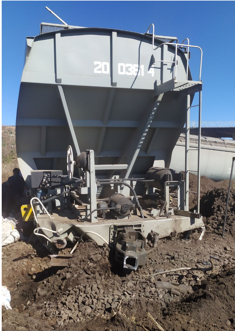
Figura 11 - Rotura de enganche entre vagones N°2003614 y N°2003663 (posición 42 y 43 respectivamente) - Fuente: Investigador en el lugar del suceso.
