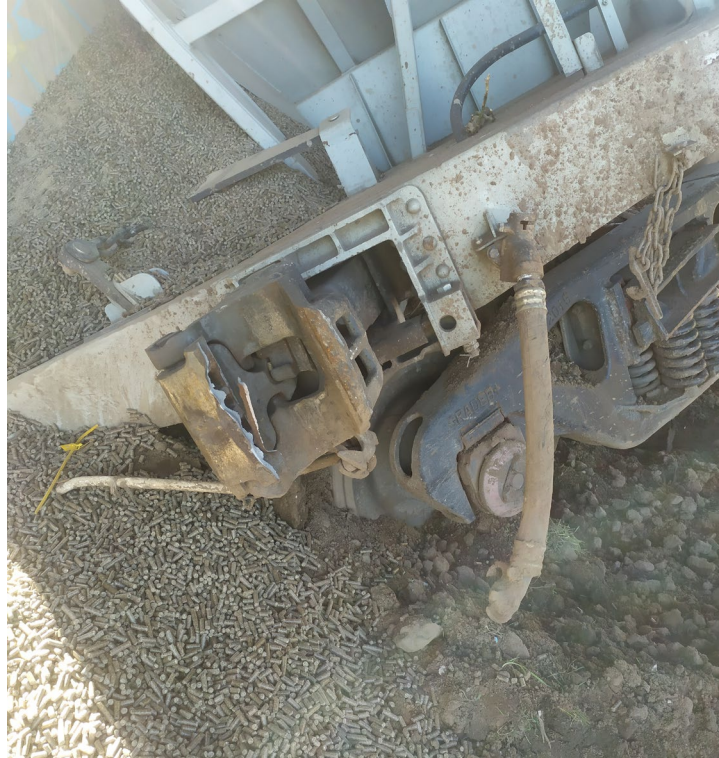
Figura 12- Pérdida de carga en el vagón N°2004828 (posición 39) Fuente: Investigador en el lugar del suceso.
