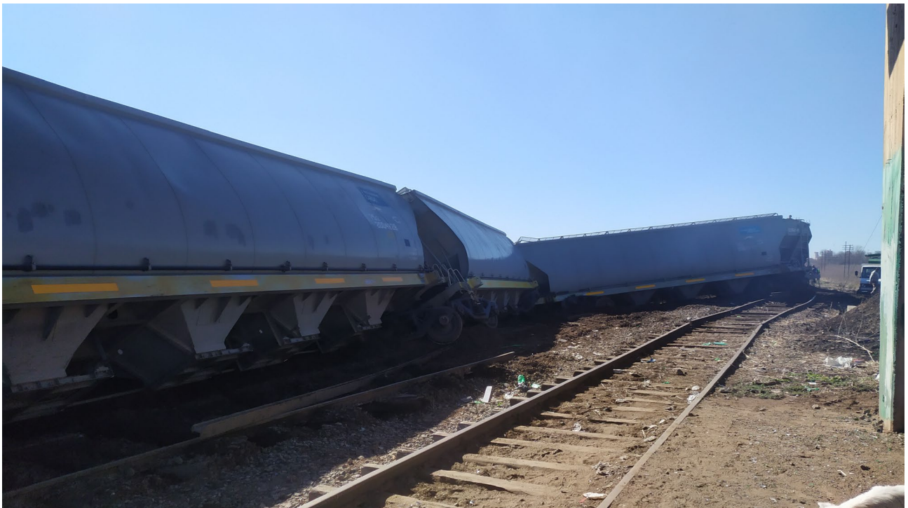
Figura 3 - Vagones descarrilados pertenecientes al tren Q02, sentido hacia Junín, Fuente: Investigador en el lugar del Suceso.
