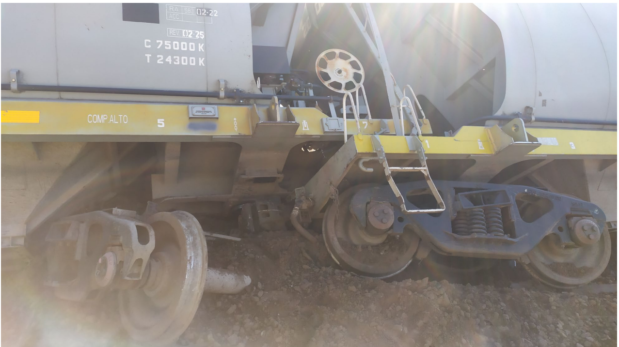
Figura 10- Colisión entre vagones N°2004828 y N°2006013 (posición 39 y 40 respectivamente) Fuente: Investigador en el lugar del suceso.
