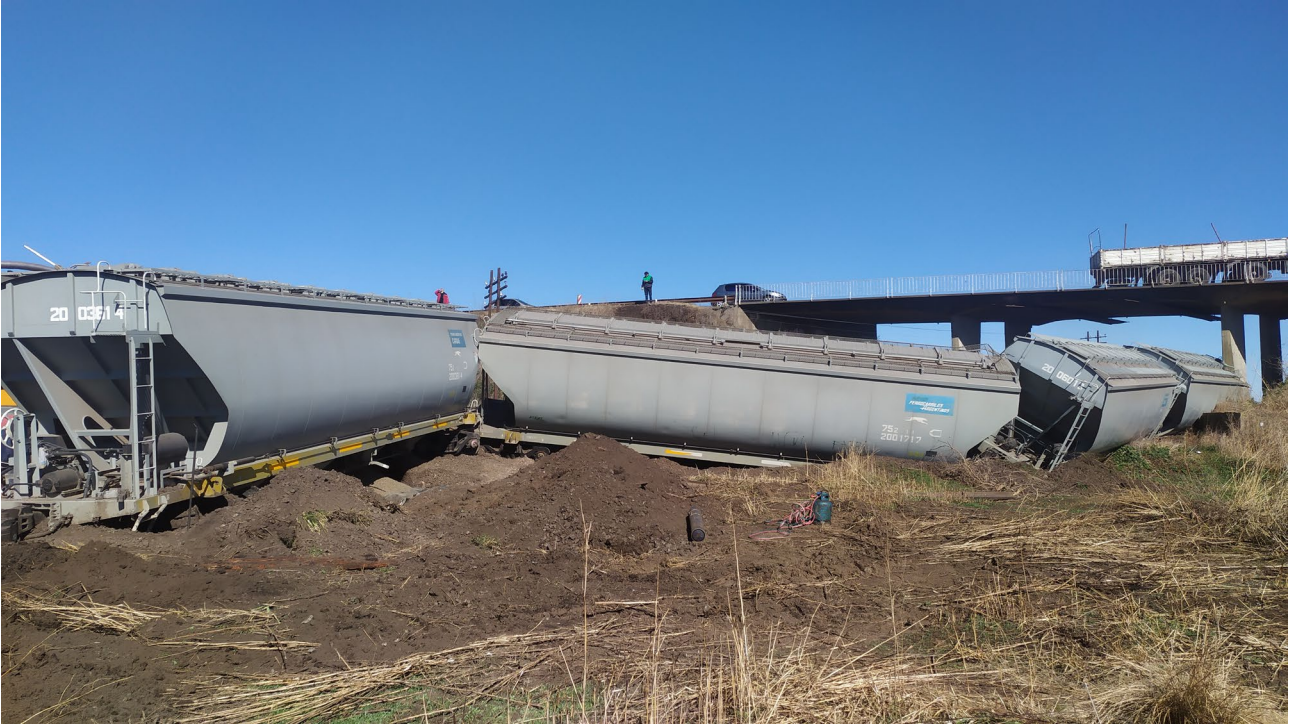
Figura 4- Vagones descarrilados pertenecientes al tren Q02, vista hacia Saforcada, Fuente: Investigador en el lugar del suceso.
