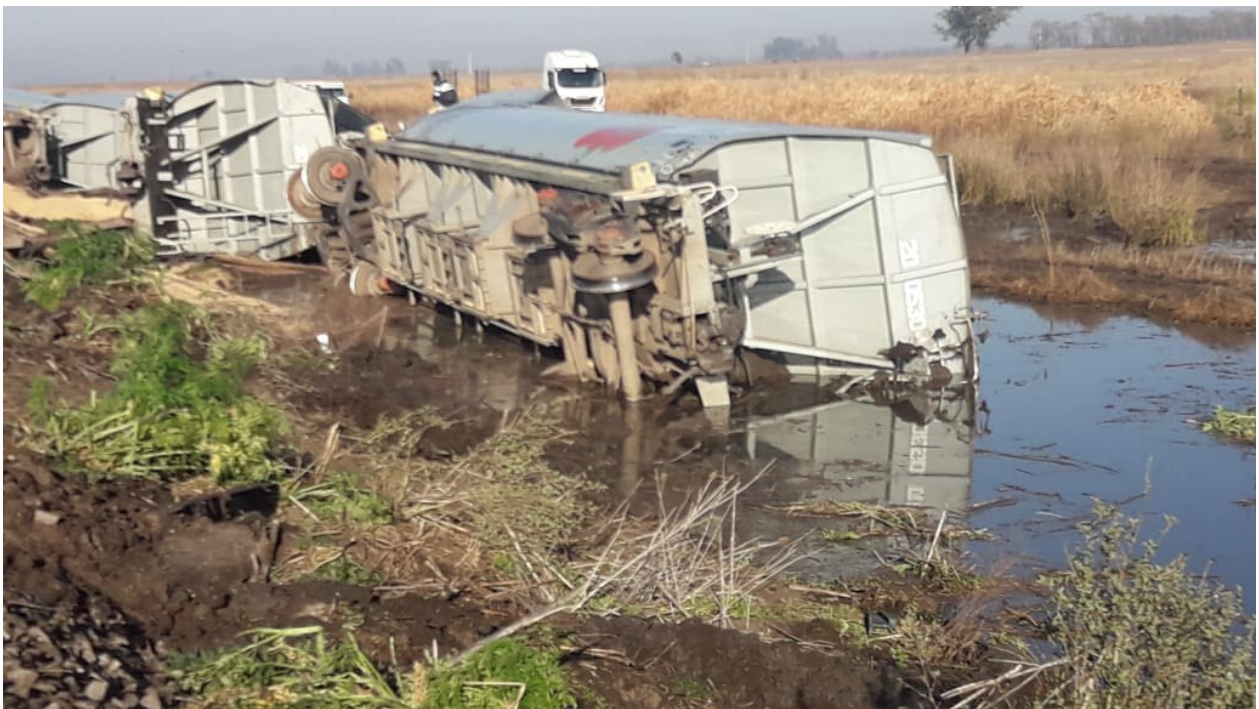
Figura 1 - Vagones tumbados sobre zanja a un lado del terraplén - Fuente: Archivo JST
