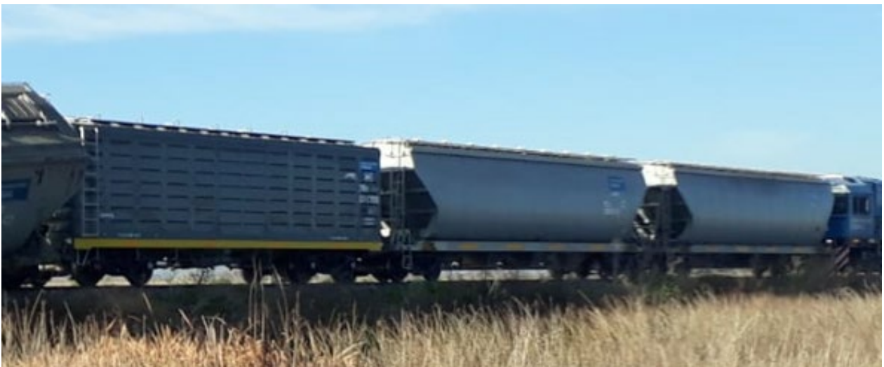
Figura 4 - vagón granero de origen nacional junto a vagones tolva de origen chino- Fuente: Archivo JST
