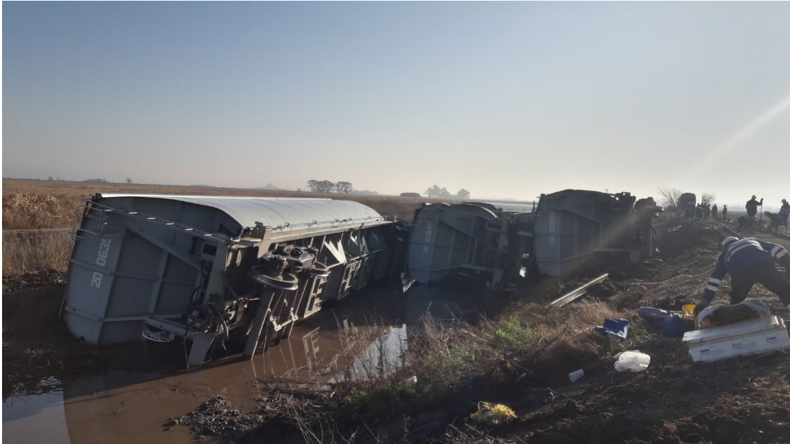
Figura 2 - Zanja paralelo al terraplén - Fuente: Archivo JST
