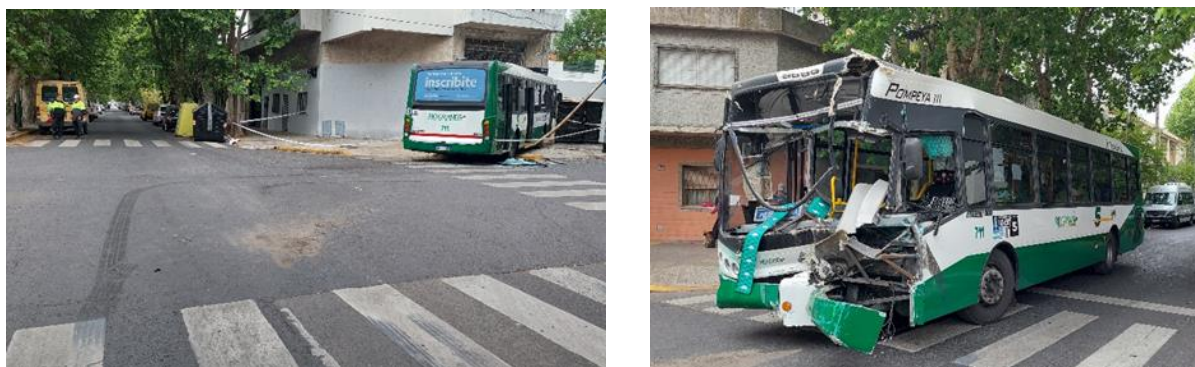
Figura 1. Posición final y daños del Vehículo 2. Fuente: JST, 2022
