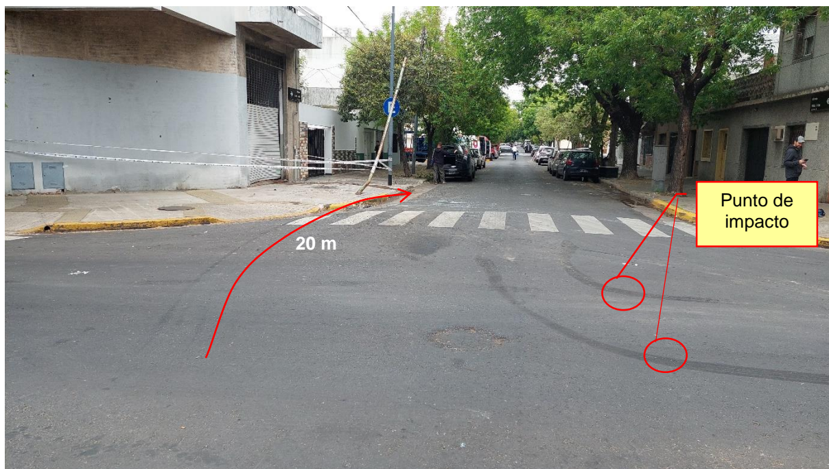
Figura 18. Huellas de derrape posimpacto del Vehículo 1. Fuente: JST, 2022
