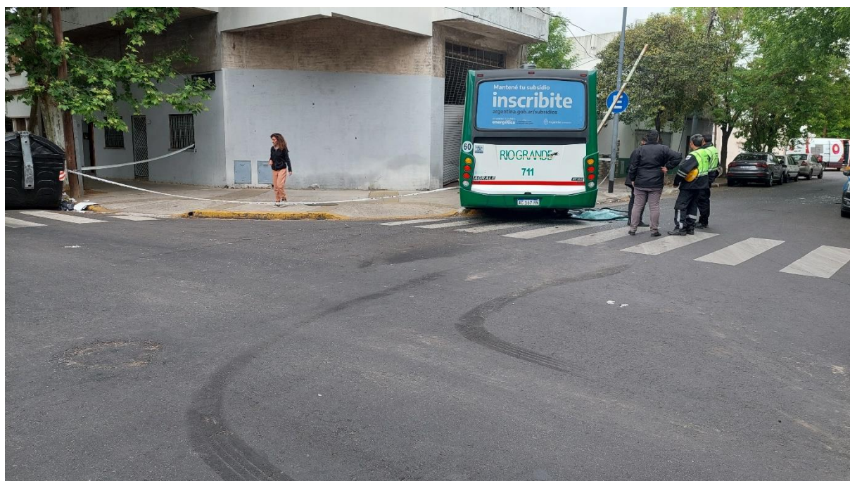
Figura 17. Continuación de las huellas de frenado del Vehículo 2 luego del impacto con el Vehículo 1. Fuente: JST, 2022
