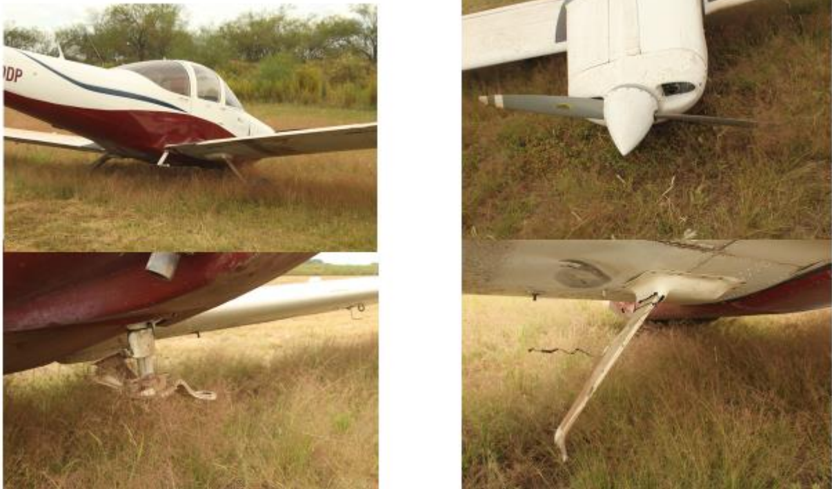
Figura 1. Imágenes de daños en la aeronave
