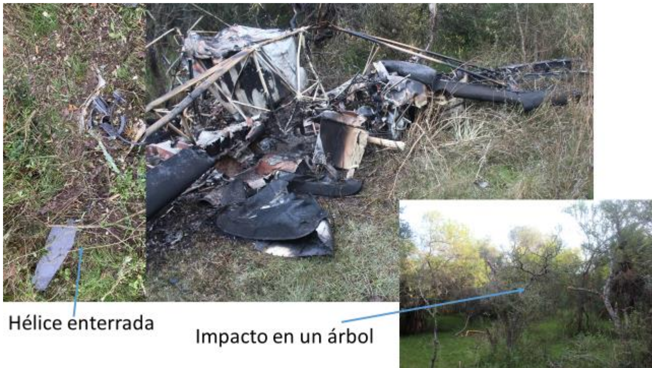
Figura 4. Detalles de la condición post accidente de la aeronave
