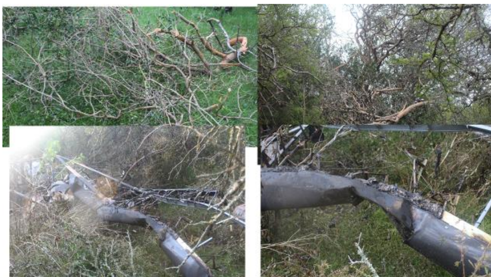
Figura 6. Detalle del borde de ataque del ala izquierda y ramas caídas. Fuente: investigación JST
