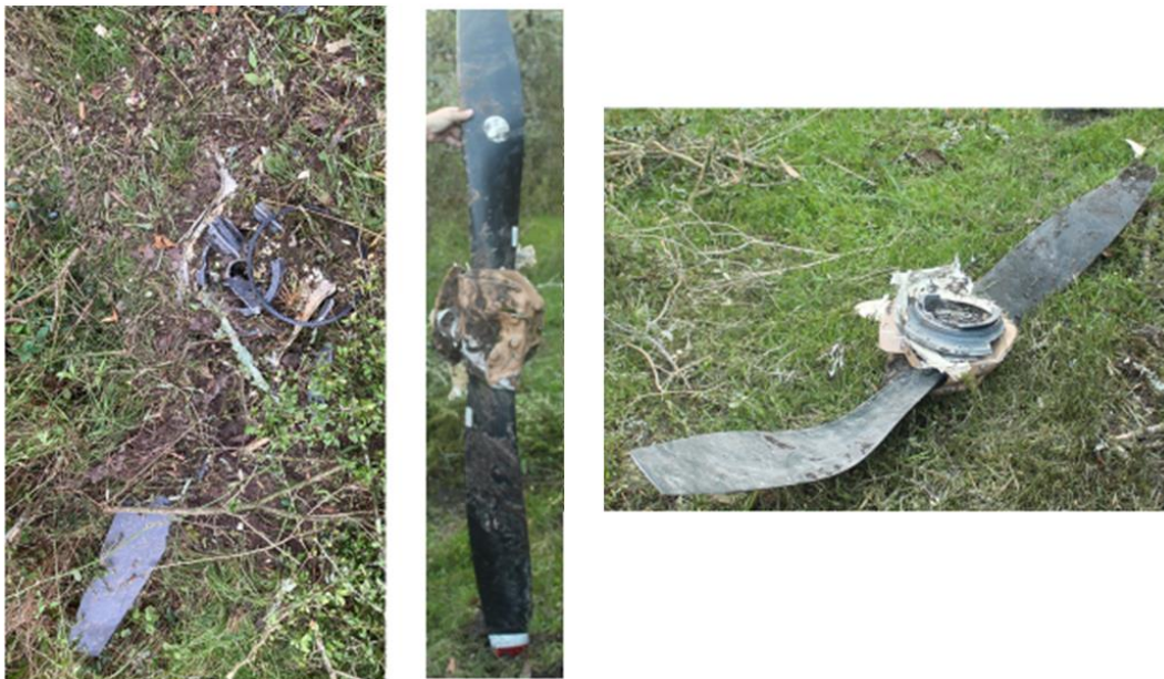
Figura 2. Daños en la hélice del LV-BNL. Fuente: investigación JST
