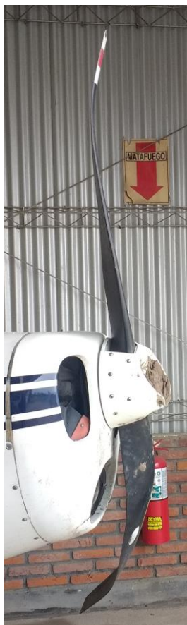
Figura 1. Condición de la hélice post impacto
