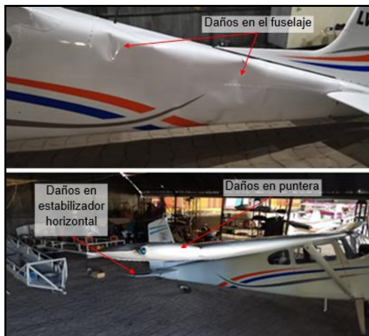
Figura 3. Imagen de los daños en la aeronave
