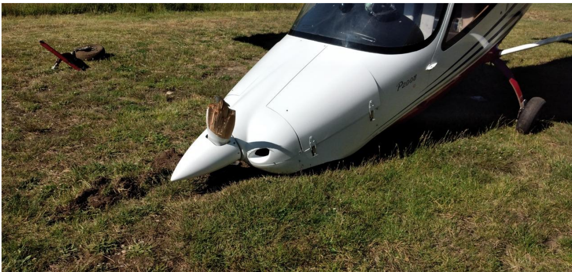
Figura 3. Daños en la hélice y dispersión de restos
