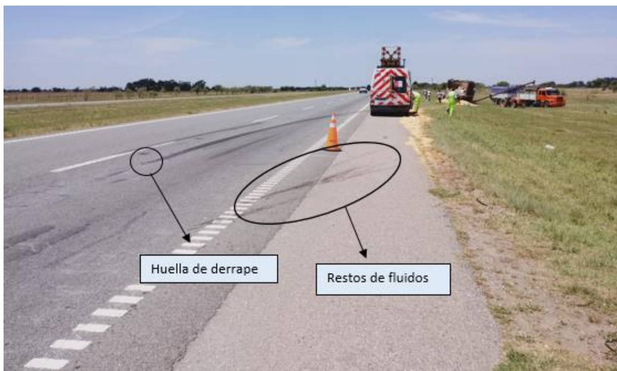
Figura 9. Huella de derrape y restos de fluido en la zona del suceso. Fuente: JST, 2022
