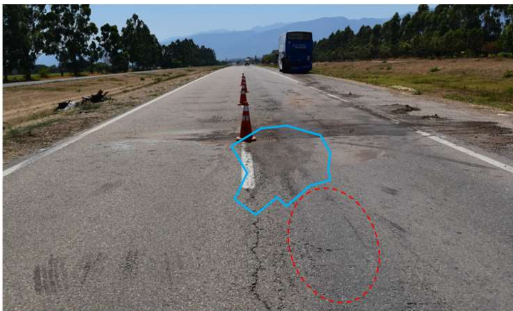
Figura 11. Ubicación de huellas de fricción. Estas marcas evidencian la zona de impacto entre los vehículos (óvalo rojo). Se observa también más adelante la deposición de tierra y fluidos dinámicos (área encerrada en celeste). Fuente: JST, 2022
