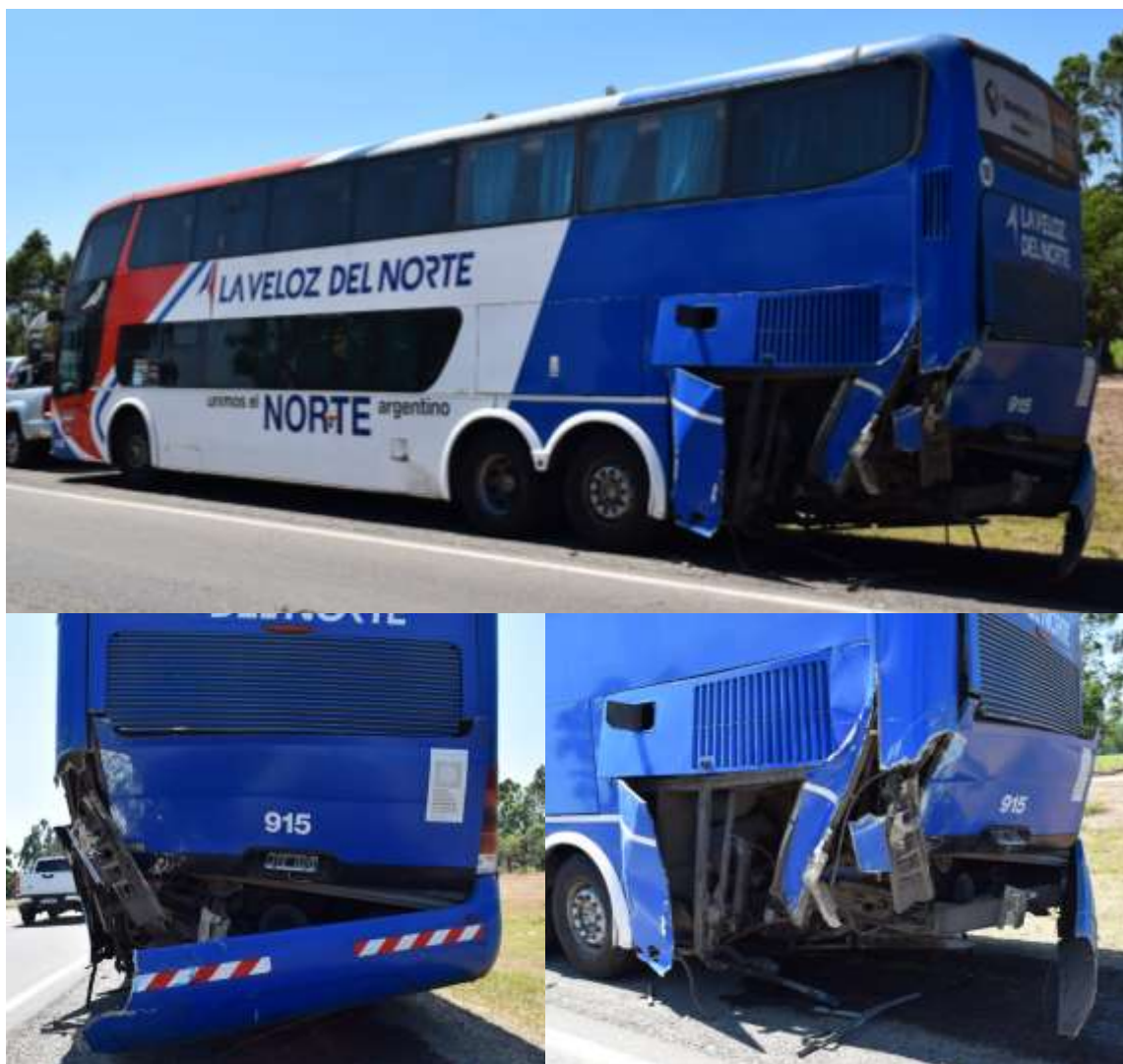
Figura 9. Daños constatados en el ómnibus. Fuente: JST, 2022
