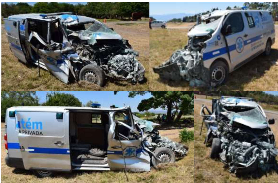
Figura 10. Daños constatados en el furgón ambulancia. Fuente: JST, 2022
