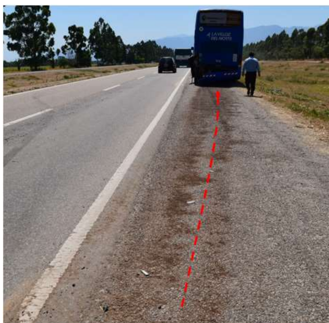
Figura 13. Fluido depositado de forma dinámica durante la trayectoria poscolisión del ómnibus sobre la banquina. Fuente: JST, 2022
