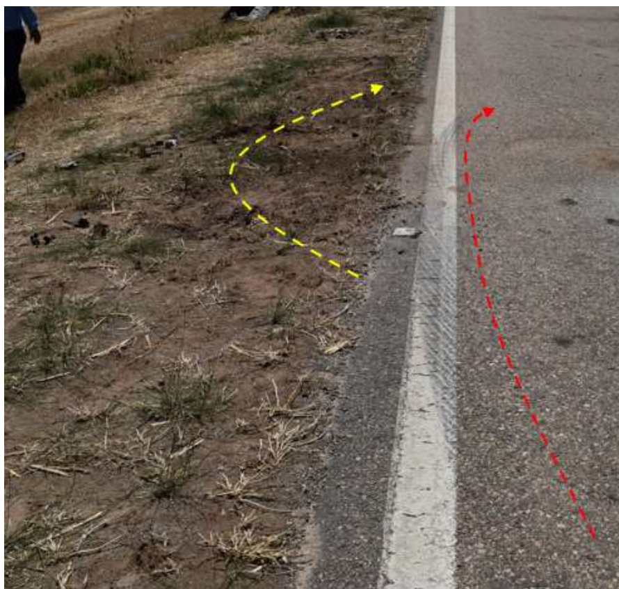
Figura 14. Huella de derrape demarcada sobre la calzada por una de las ruedas posteriores del furgón durante su trayectoria poscolisión (flecha punteada en rojo). Se observa también la remoción de tierra y pasto del cantero central (flecha punteada en amarillo). Fuente: JST, 2022
