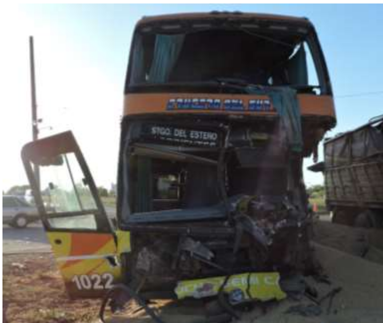
Figura 6. Detalle de daños en la parte frontal del Vehículo 1. Fuente: JST, 2022
