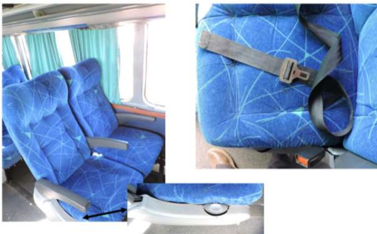
Figura 8. Detalle del estado y conservación de cinturones de seguridad durante el relevamiento. Fuente JST, 2022
