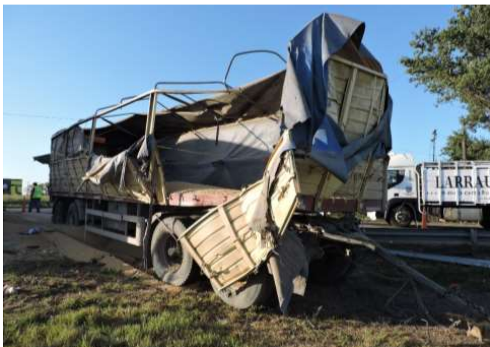
Figura 10. Detalle de daños en la parte lateral derecha del Vehículo 2. Fuente: JST, 2022
