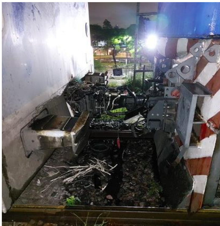
Figura 7. Daños en el enganche de la locomotora A901 y el primer coche de la formación. Fuente: JST, 2021
