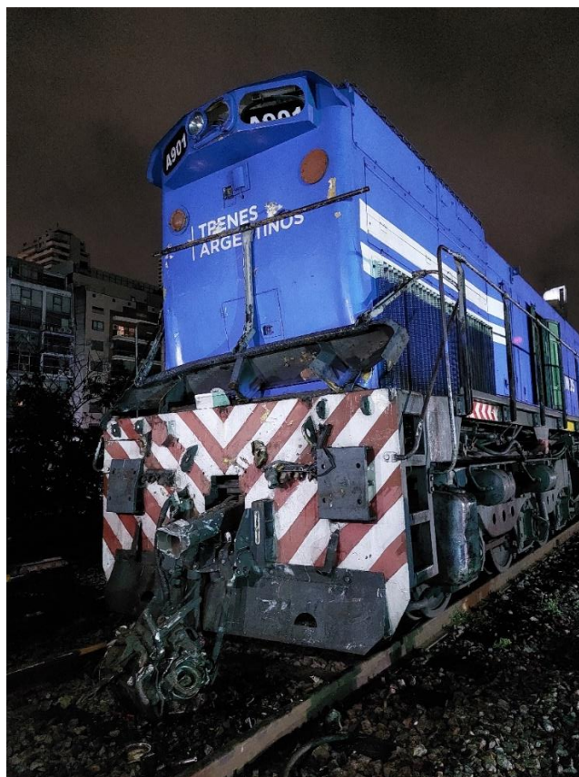
Figura 6. Daños en la locomotora A901. Fuente: JST, 2021
