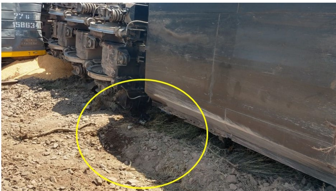
Figura 14. Pérdida de combustible de la locomotora 9771 Fuente: Archivo JST
