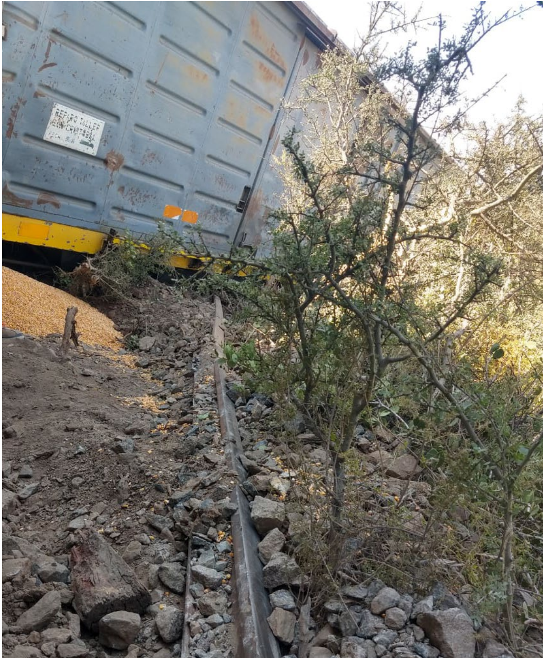
Figura 3. Vagones descarrilados pertenecientes al tren N.º 1416. Fuente: Archivo JST
