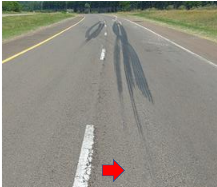
Figura 8. Marcas de neumático sobre la calzada que indican el posible punto de colisión. Fotografía tomada en el sentido de marcha de las unidades. Fuente: JST, 2023
