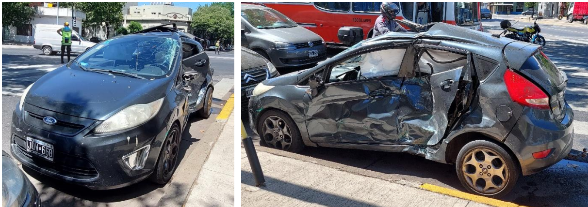
Figura 10. Daños adquiridos en la colisión con el Vehículo 1. Fuente: JST, 2023
