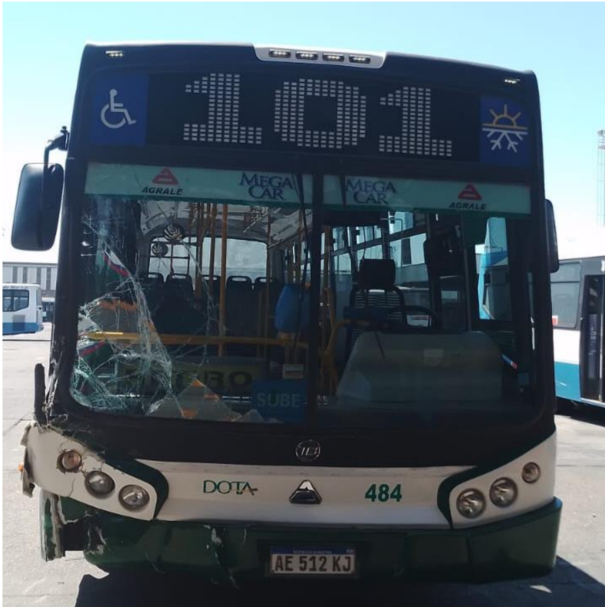
Figura 9. Daños adquiridos por el Vehículo 1 en la colisión con el Vehículo 2. Fuente: DOTA, 2023
