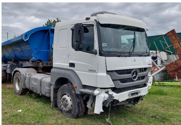
Figura 8. Extensión de los daños hacia los laterales. Fuente: JST, 2023
