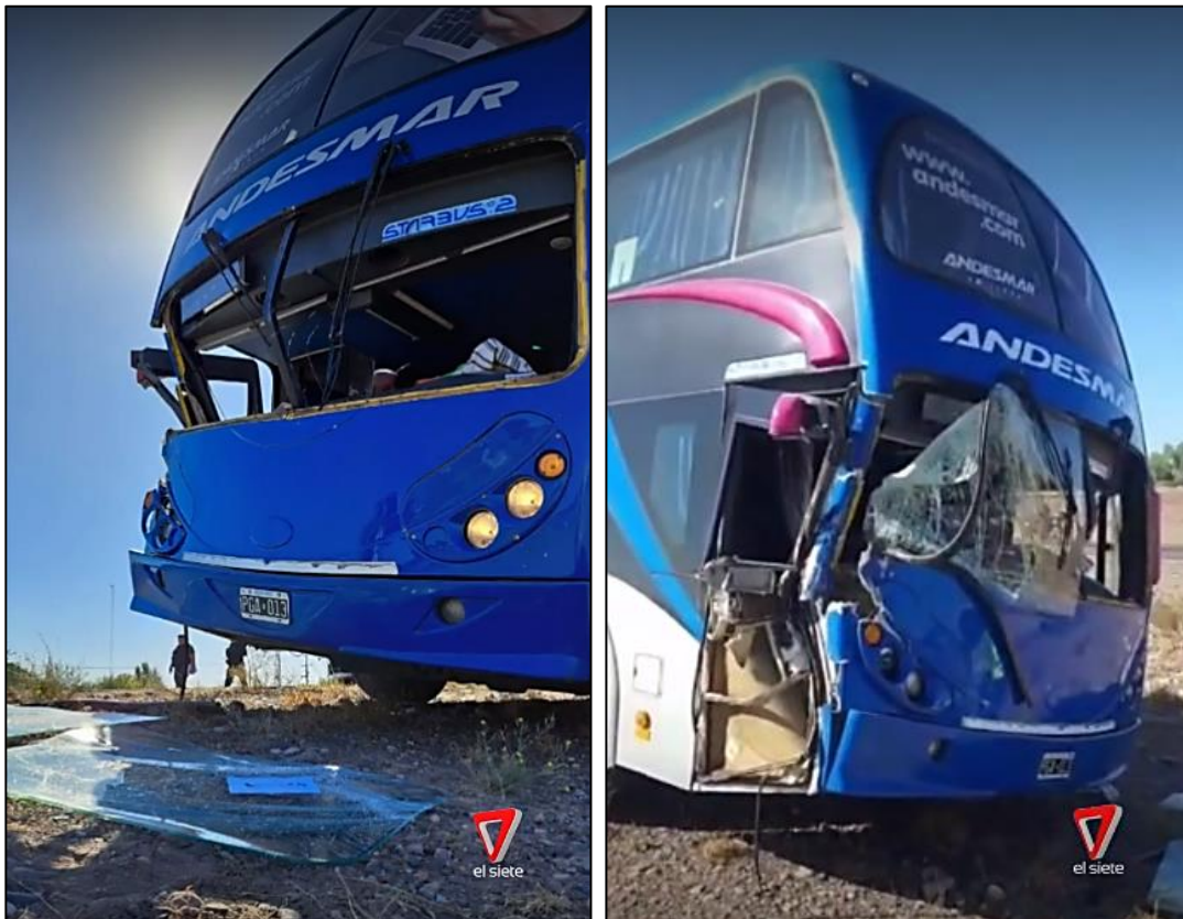
Figura 7. Daños materiales en el Vehículo 1. Se observa el vértice anterior inferior derecho afectado.
