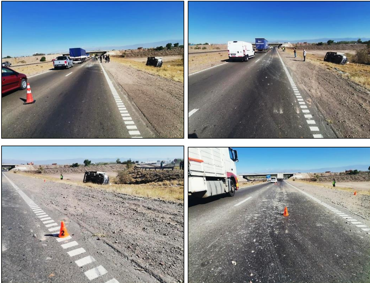
Figura 10. Fotografías del accidente. Se observan restos vehiculares sobre el carril derecho, huellas de derrape sobre la banquina y talud norte. Así también, la posición final del Vehículo 1. Fuente: Acta de accidente Nro. 686/23 de la Municipalidad de Maipú, 2023
