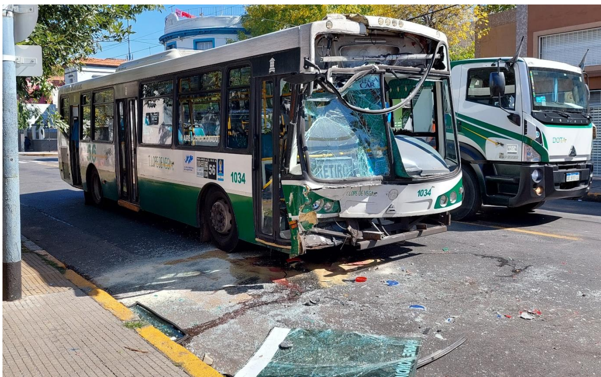
Figura 10. Restos de carrocería y mancha de fluidos mecánicos que determinan la zona de colisión. Posición final del Vehículo 1. Fuente: JST, 2023
