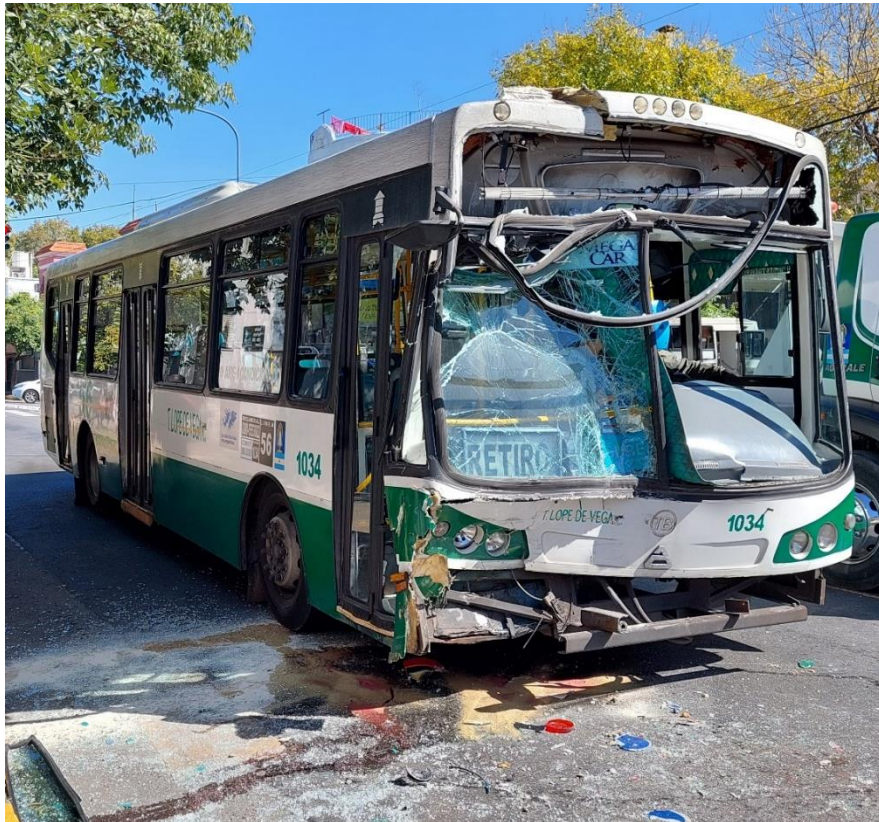
Figura 7. Daños originados en la colisión por alcance con el Vehículo 2. Fuente: JST, 2023
