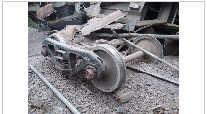
Figura 2. Desprendimiento de bogie. Fuente: JST
