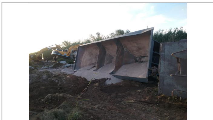
Figura 3. Imagen de un vagón descarrilado con pérdida de carga y trabajos de encarrilamiento. Fuente: JST, 2023
