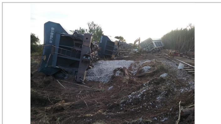
Figura 2. Imagen de los vagones descarrilados. Fuente: JST, 2023
