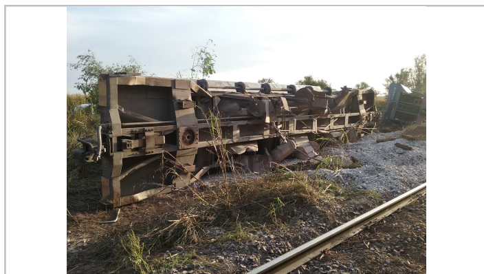
Figura 4. Imagen de un vagón descarrilado con desprendimiento de bogies. Fuente: JST, 2023
