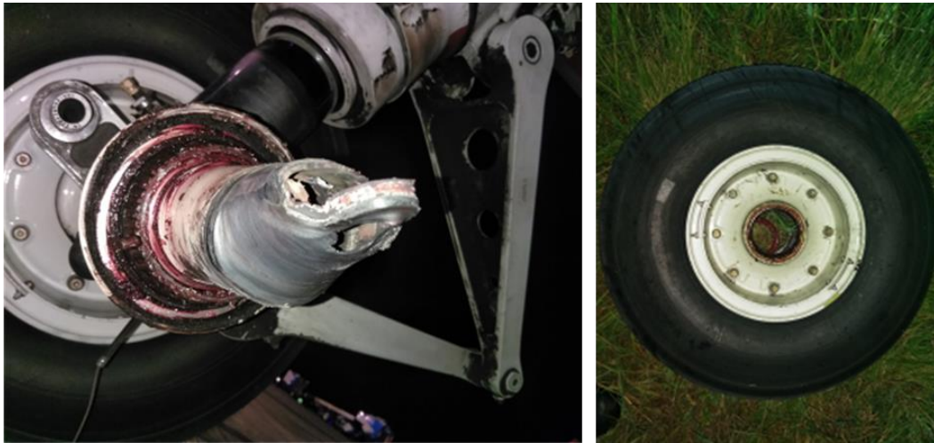
Figura 2. Extremo del eje y rueda en la condición encontrada. investigación JST
