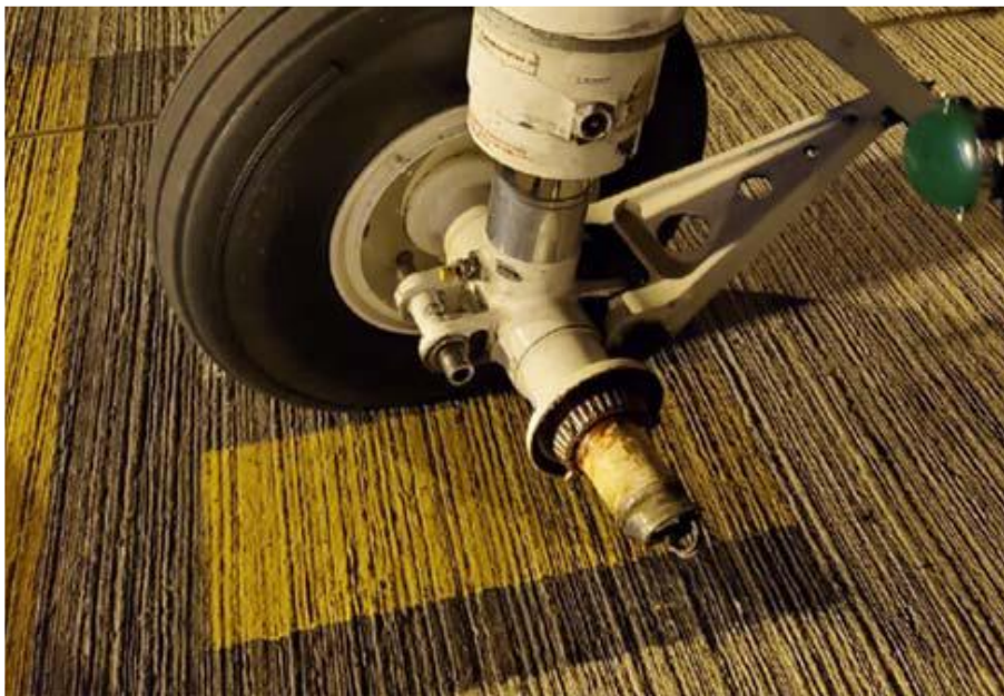
Figura 1. El LV-CHQ estacionado con una rueda faltante. Fuente: investigación JST
