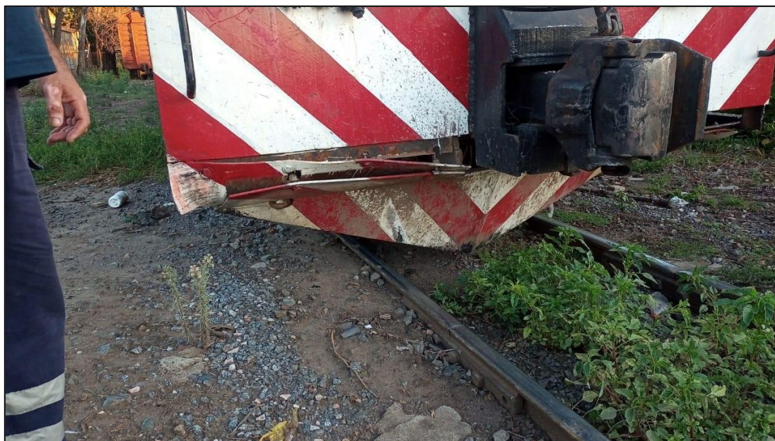
Figura 3. Daños en miriñaque. Fuente: BCyL, 2023
