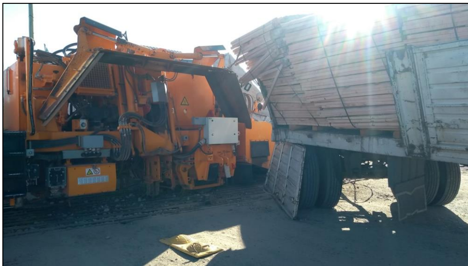
Figura 11. Posición y ubicación final de la perfiladora-reguladora luego del impacto y descarrilamiento
