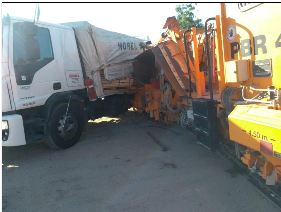
Figura 12. Zonas de impacto entre la maquinaria y el camión
