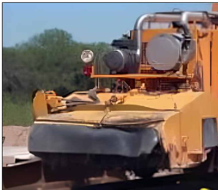
Figura 2. Daños en la parte frontal de la reguladora-perfiladora de balasto. Fuente: BCyL
