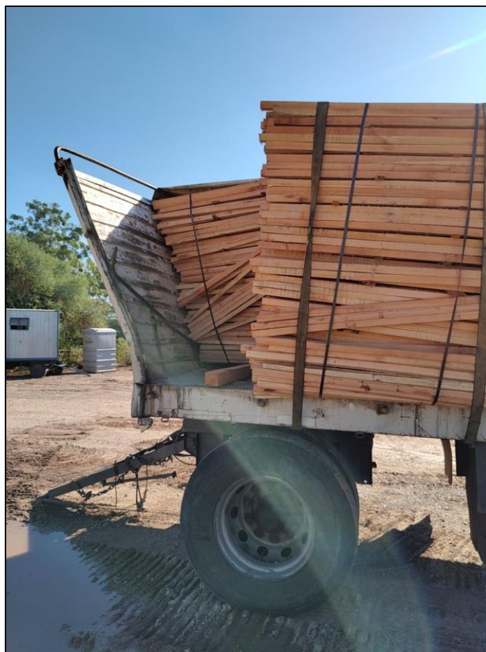
Figura 4. Daños estructurales en el acoplado. Fuente: JST
