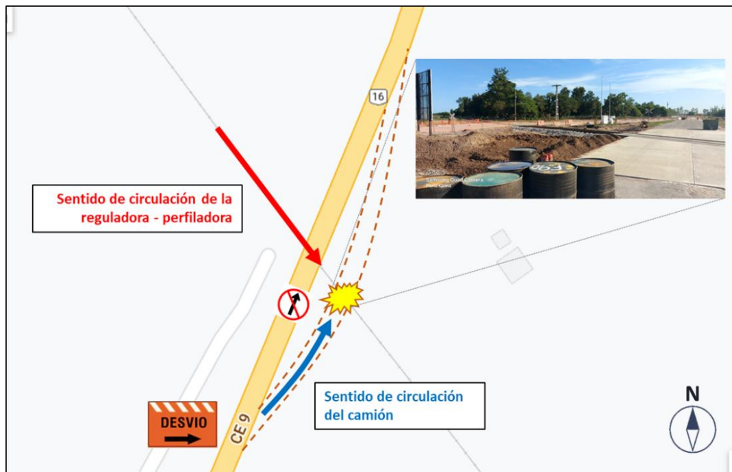
Figura 9. Mapa de la ubicación del accidente. Sentidos de dirección de la perfiladora y del camión Fuente: Google Maps. Fotografía de la JST, relevamiento de campo, 2022
