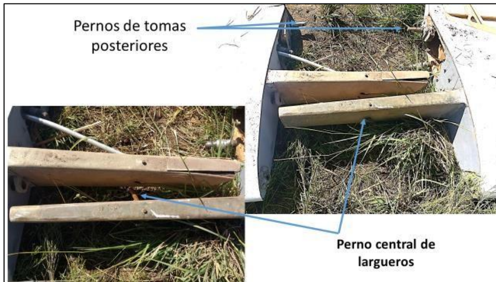
Figura 12. Elementos de unión de largueros y alas. Fuente: investigación JST
