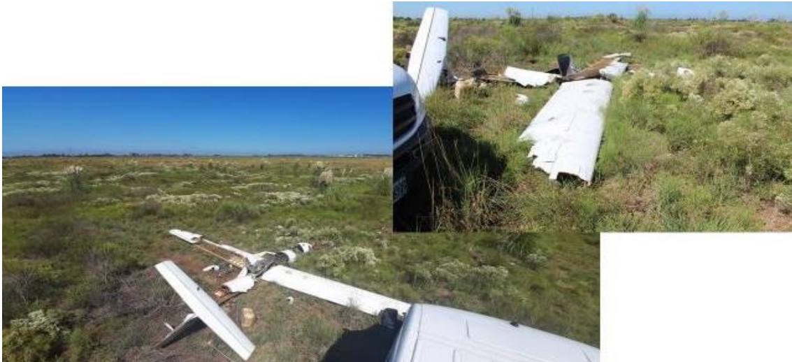
Figura 14. Presentación de las partes mayores del planeador. Fuente: investigación JST
