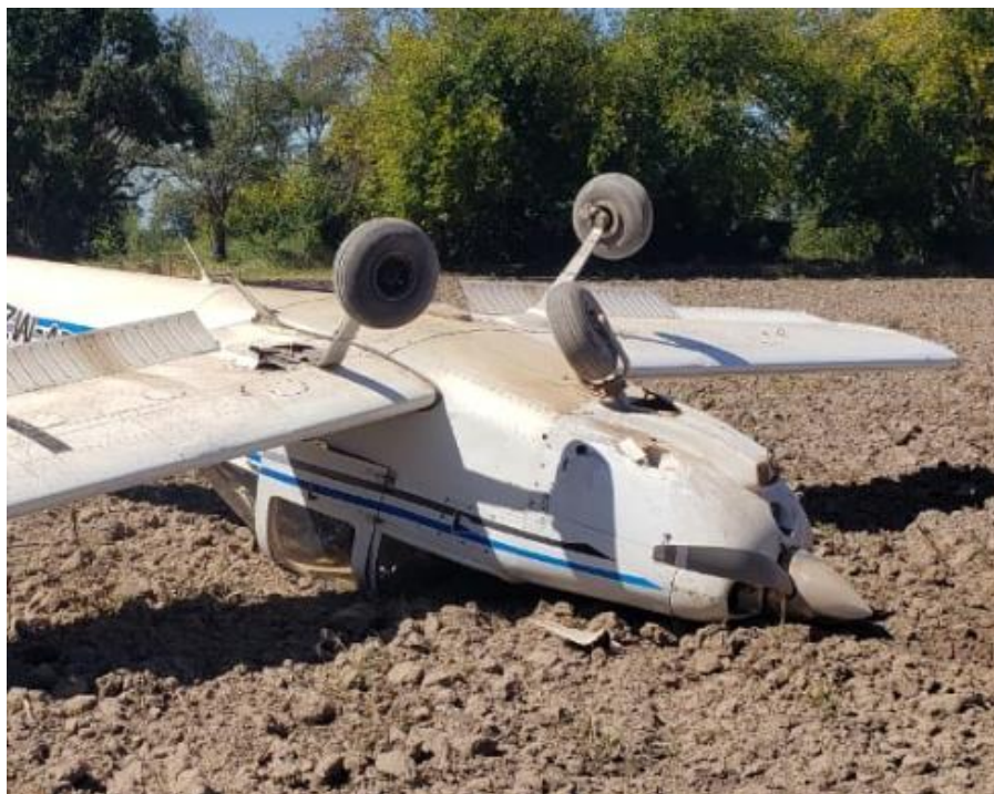
Figura 3. Daños en el tren de aterrizaje. Fuente: investigación JST
