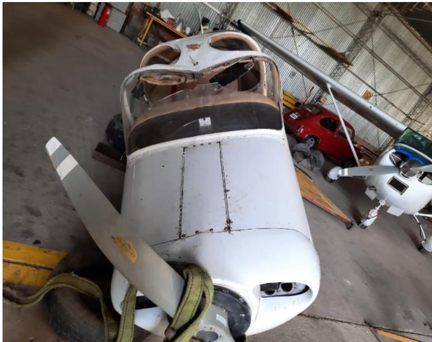
Figura 4. Daños en la parte superior de la cabina y en la hélice. investigación JST
