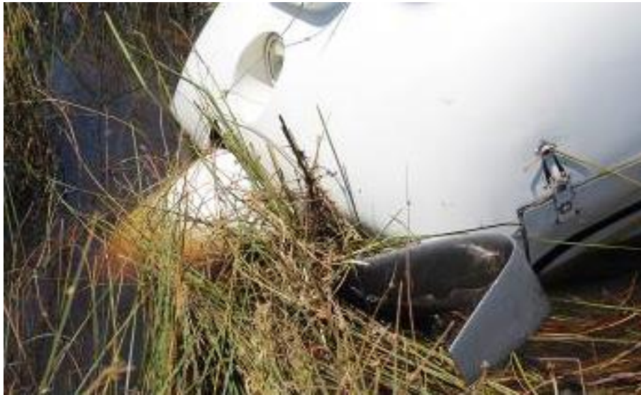
Figura 2. Deformación de la hélice. Fuente: investigación JST
