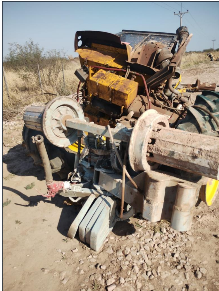
Figura 1. Restos de la maquinaria de vía afectada por el choque. Fuente: JST, 2023
