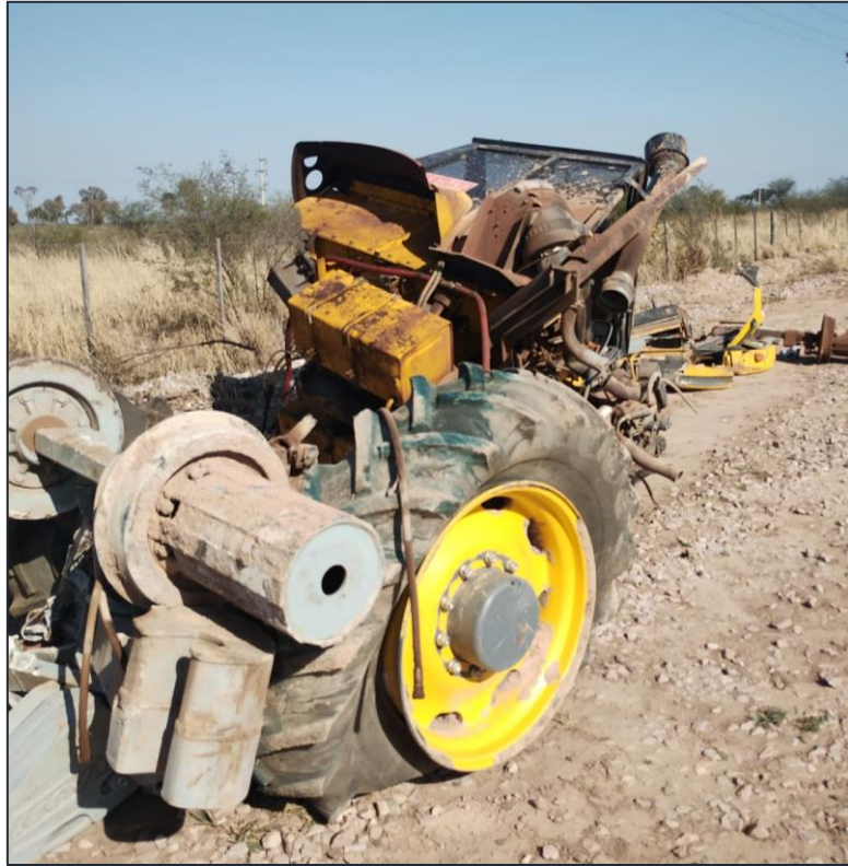
Figura 3. Imagen de un tractor marca Pauny con equipo bi-vial, parte de la maquinaria de vía afectada por el suceso. Fuente: JST, 2023
