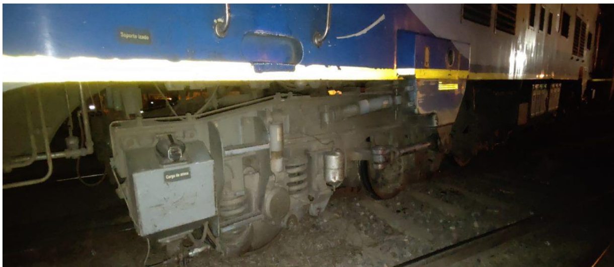
Figura 5. Coche descarrilado. Fuente: JST, 2022
